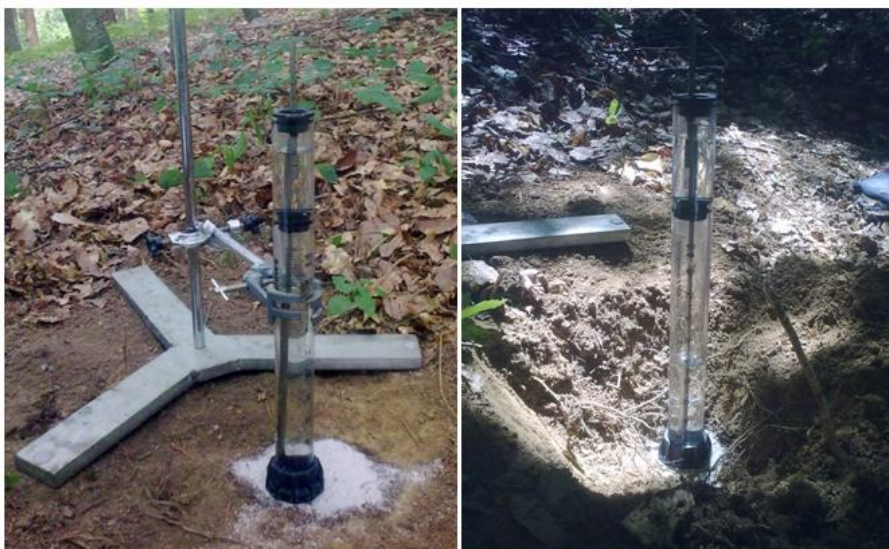
Slika 17: Izvajanje meritev v nivoju tal (levo) in v vkopu (desno) na rendzini
