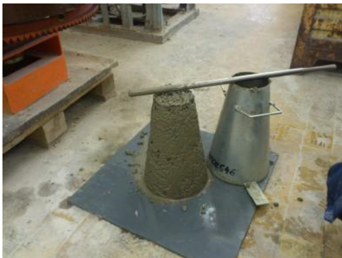
Slika 29: Posed betonskega stožca.
