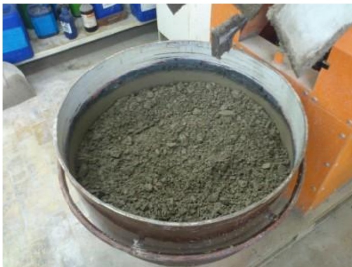
Slika 26: Priprava kompozita II v laboratorijskem mešalcu.
