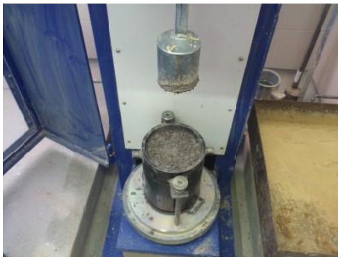
Slika 27: Zgoščevanje po modificiranem Proctorjevem postopku.
