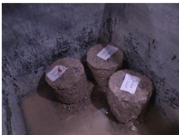
Slika 33: Razpadli kompozit I po 4-urni negi v vodi.
