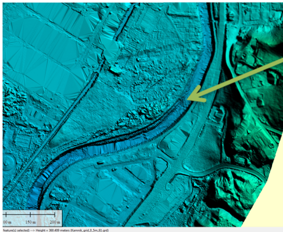
Slika 27: Sipina 2 vidna na LIDAR posnetku (Banovec, 2013).
