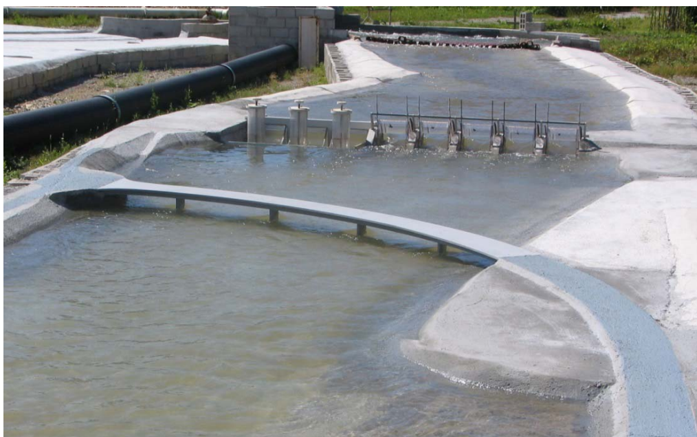
Slika 1: Fizični model odseka reke Save nad mestom Krško z jezovno zgradbo HE Krško in načrtovanim mostom regionalne ceste Krško–Brežice (Hidroinštitut, 2011).
