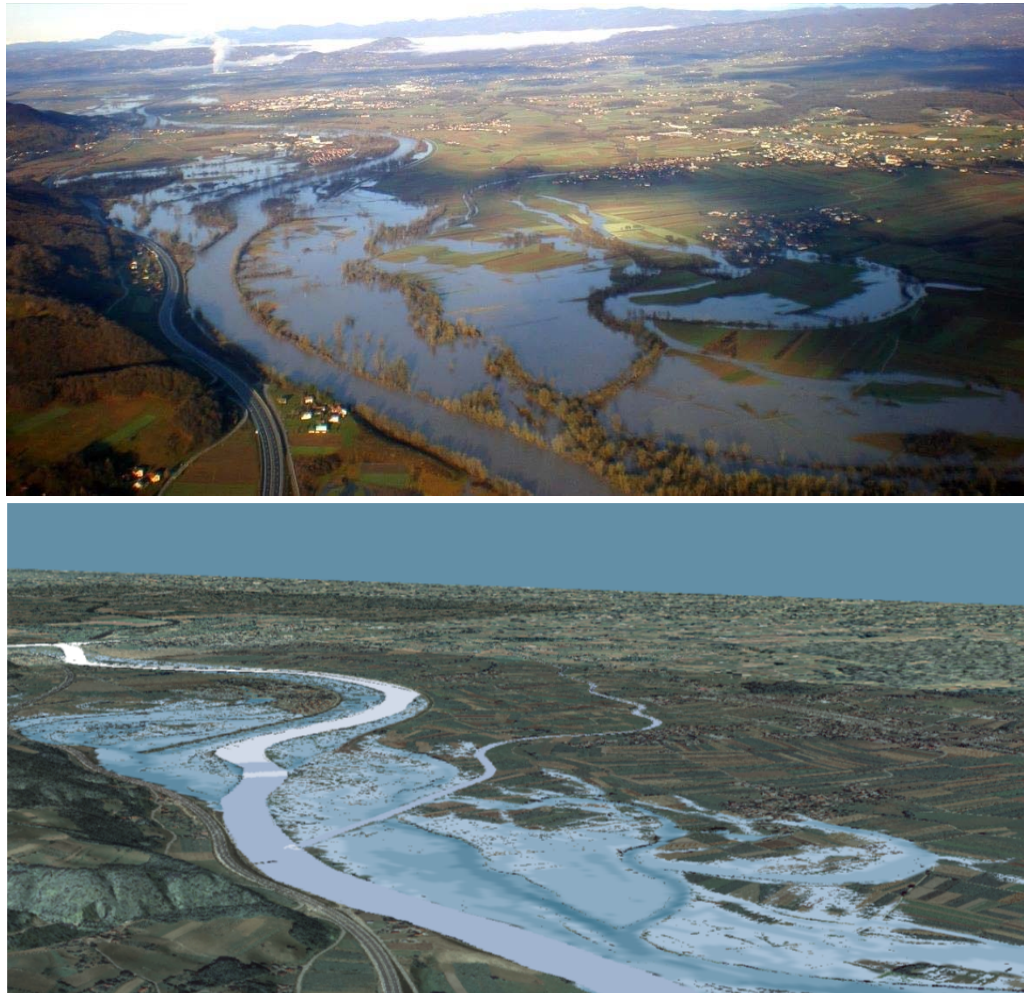
Slika 36: Primerjava obsega poplavljenosti za visokovodni dogodek decembra 2009. Zgoraj – fotografija iz zraka obsega poplave ob dogodku 26. 12. 2009 (POP TV); spodaj – 3D prikaz izračunanega obsega s hidravličnim modelom (Steinman in sod. 2012).
