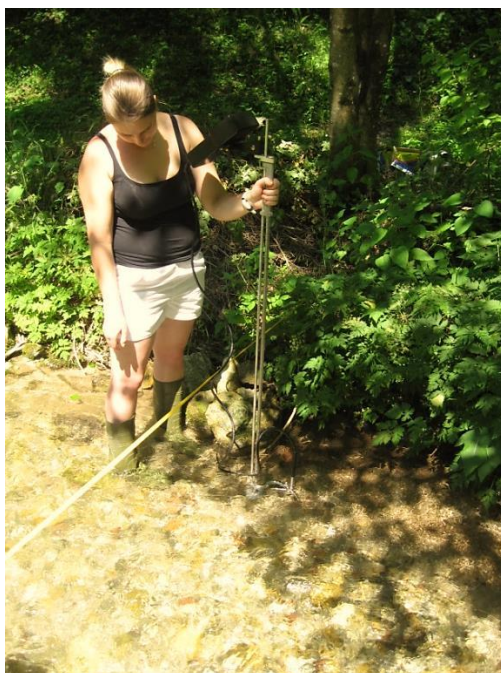
Slika 53: Izvajanje meritve z instrumentom FlowTracker Handheld ADV
