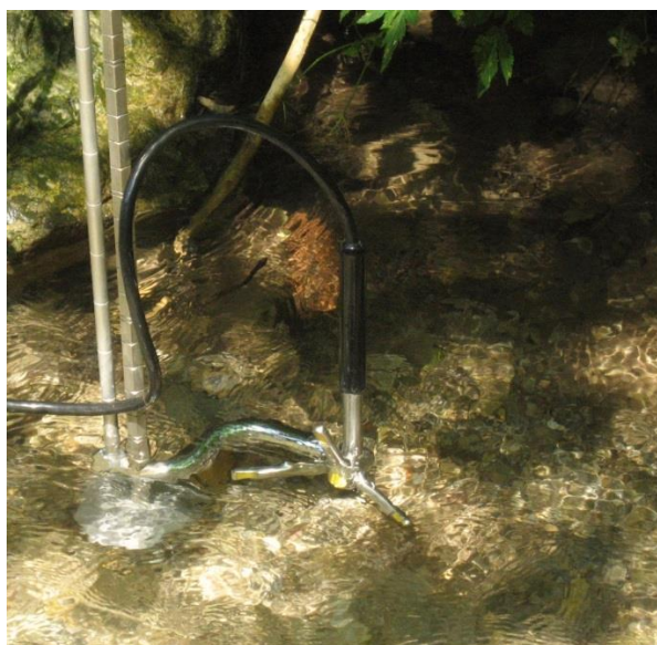
Slika 52: Pravilna postavitev sonde
