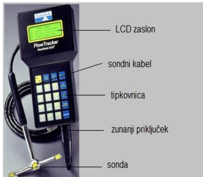
Slika 18: Dopplerjev merilnik pretočnih hitrosti FlowTracker Handheld ADV SonTek (Hoskin, 2013)
