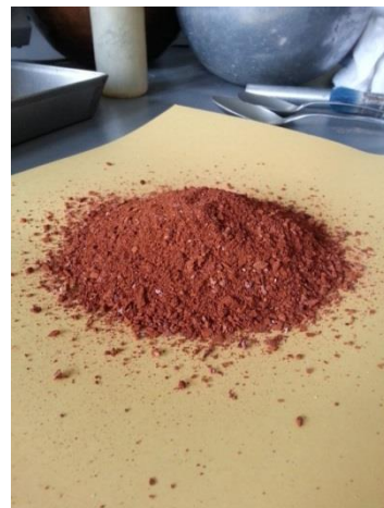
Slika 29: Skoraj suh agregat 0,063/4 mm z zaobljenim vrhom nasipnega stožca in krivuljasto obrobo površine
