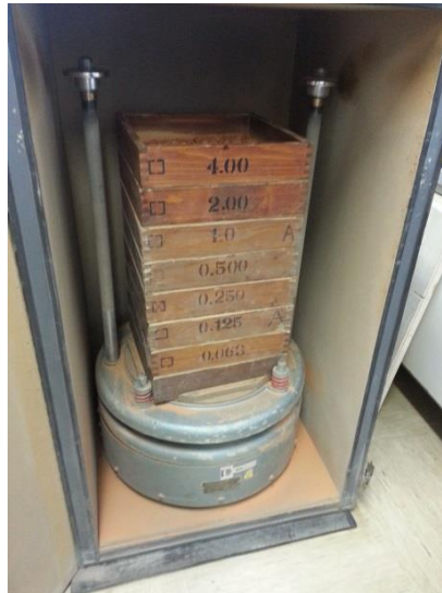
Slika 16: Naprava za sejalno analizo s siti različne velikosti
