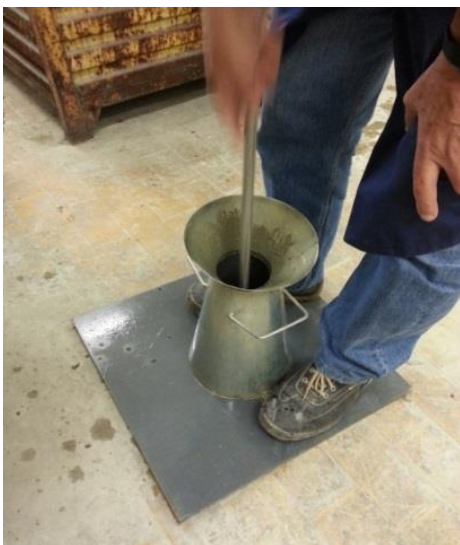
Slika 39: Vgradnja betona v kalup
