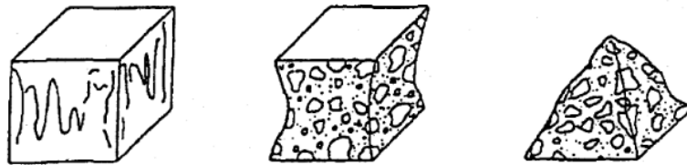
Slika 47: Zadovoljive porušitve preizkušancev v obliki kocke po standardu SIST EN 12390-3
