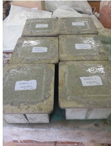
Slika 37: Vzorci svežega betona vgrajeni v kalupe in označeni
