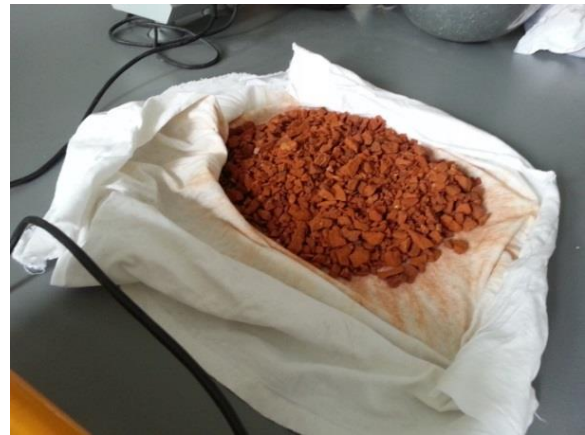
Slika 23: Površinsko osušeni reciklirani agregat
