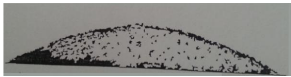
Slika 33: Agregat je skoraj suh - vrh je zaobljen, obroba površine je podobna krivulji
