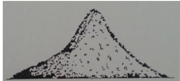
Slika 31: Rahlo vlažen agregat - opaziti je občuten padec
