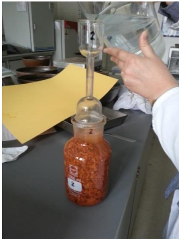
Slika 26: Nalivanje vode v piknometar
