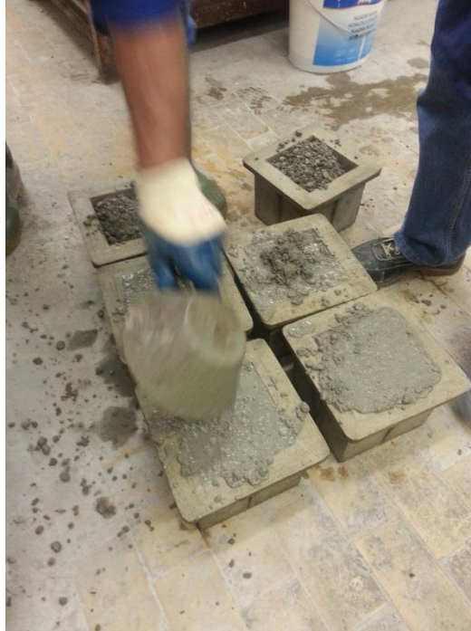
Slika 38: Polnjenje kalupov z betonom
