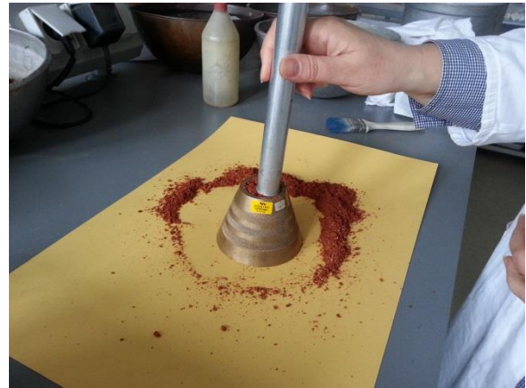
Slika 27: Preskus vpivanja vode pri metodi za preverjanje površinsko suhega z vodo zasičenega stanja za frakcijo 0,063/4 mm
