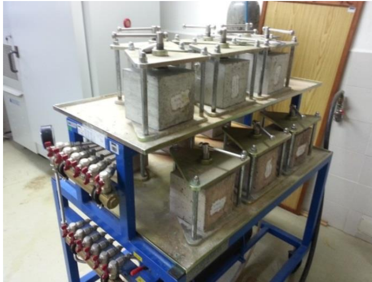
Slika 49: Naprava za določanje globine prodora vode pod pritiskom
