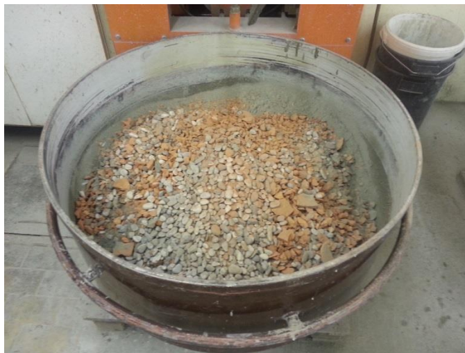
Slika 34: Suh agregat pripravljen za suho mešanje
