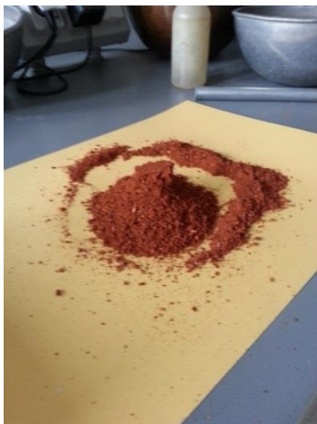
Slika 28: Vlažen agregat 0,063/4 mm, ki ohranja skoraj popolno obliko kovinskega kalupa
