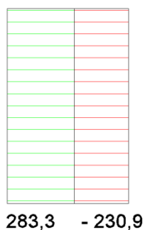
Slika 89: Ovojnica projektnih prečnih sil v stebru S1 pri kombinaciji vplivov za potresna projektna stanja [kN]
