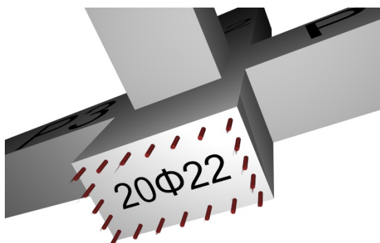
Slika 84: Shematski prikaz razporeditve vzdolžne armature v stebri S1
