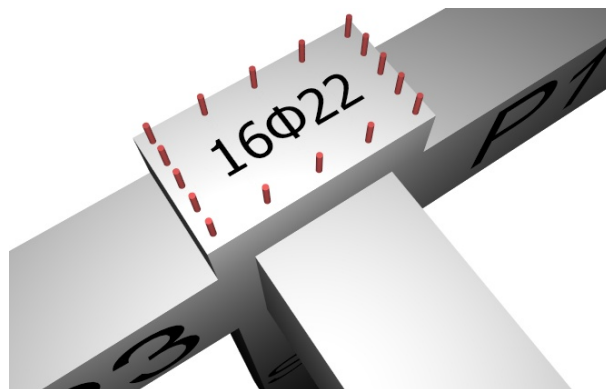
Slika 87: Shematski prikaz razporeditve vzdolžne armature v stebri S2
