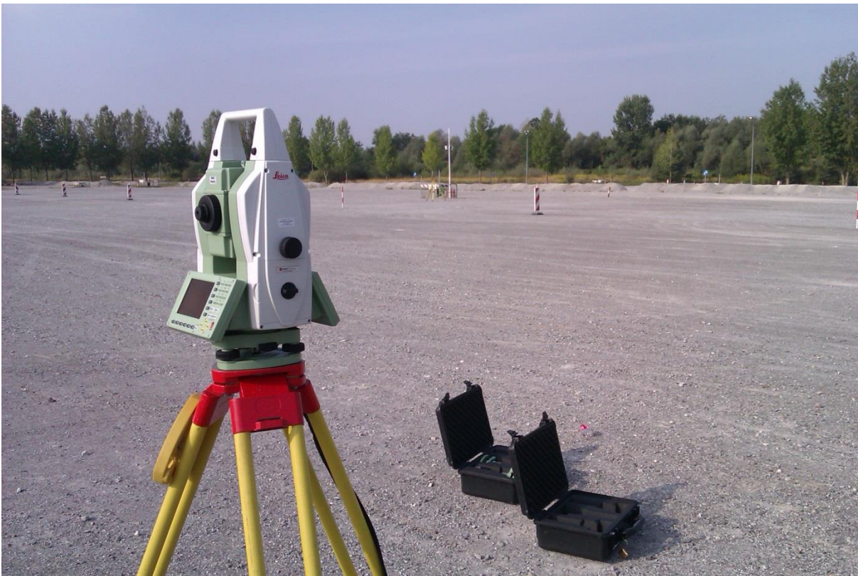
Slika 3: Tahimeter Leica TS30 postavljen na točki A1
