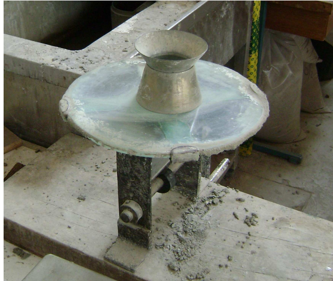
Slika 5.1: Stresalna mizica s konusnim lijakom in nastavkom za polnjenje.
