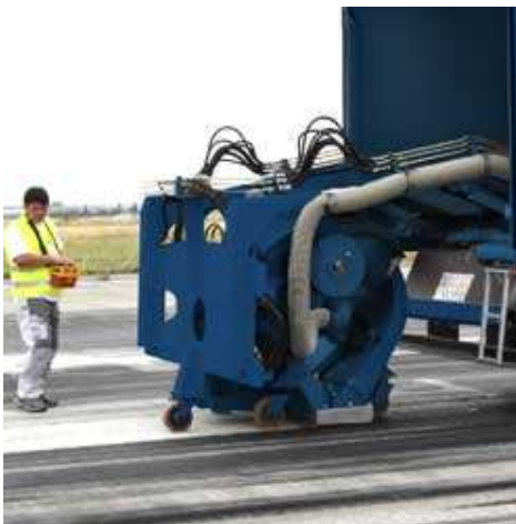
Slika 2.2: Primer opreme za peskanje z jeklenimi kroglicami.
