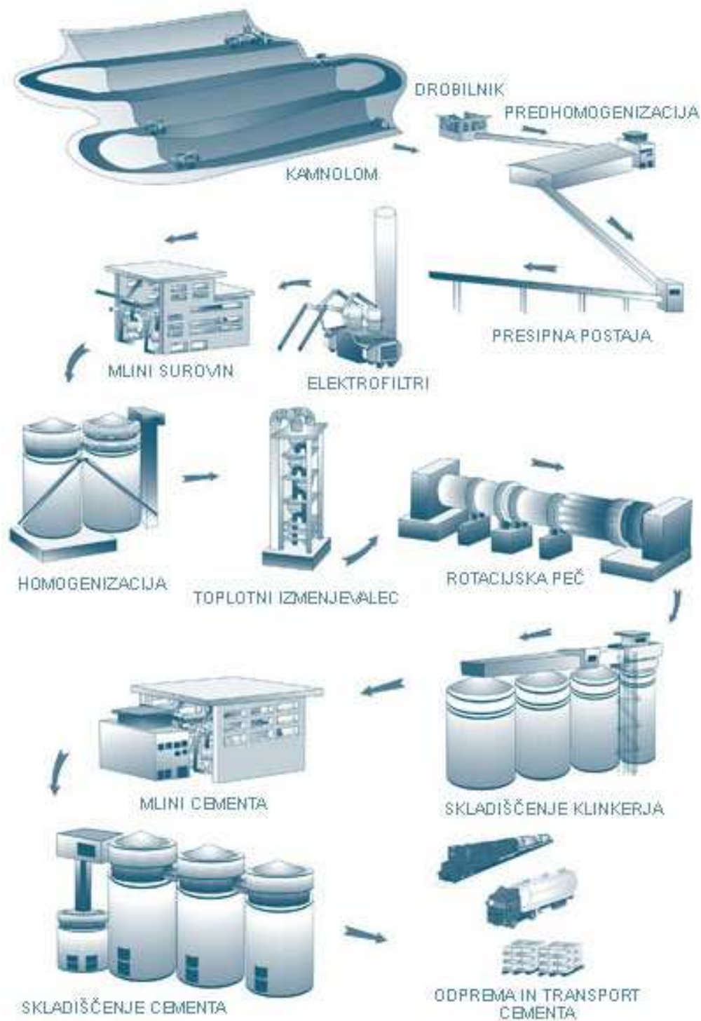
Slika 3.1: Shema proizvodnje cementsa [www.salonit.si].
