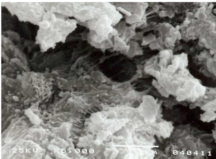
Slika 4.3: Povečava s polimeri modificiranega betona pri P/C 0,2 [Bokan-Bosiljkov, 1996].
