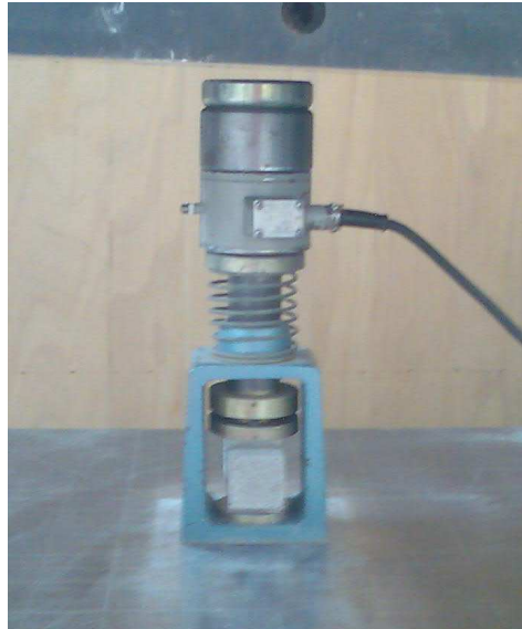
Slika 5.6: Preiskava tlačne trdnosti v laboratoriju.
