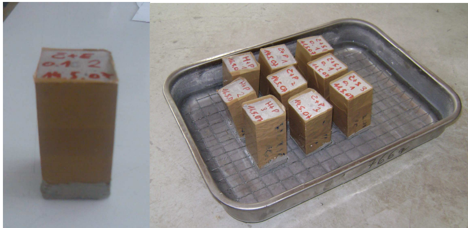
Slika 5.7: Vzorec pripravljen za merjenje vpijanja vode in vzorci na katerih že poteka preiskava vpijanja vode.
