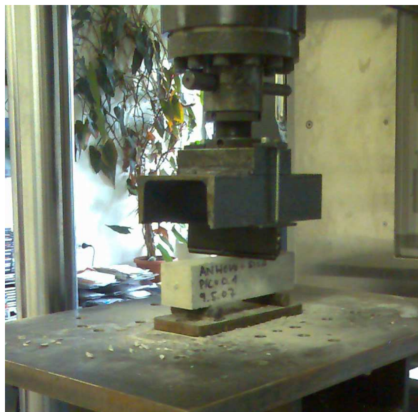
Slika 5.4: Preiskava upogibne trdnosti v laboratoriju.
