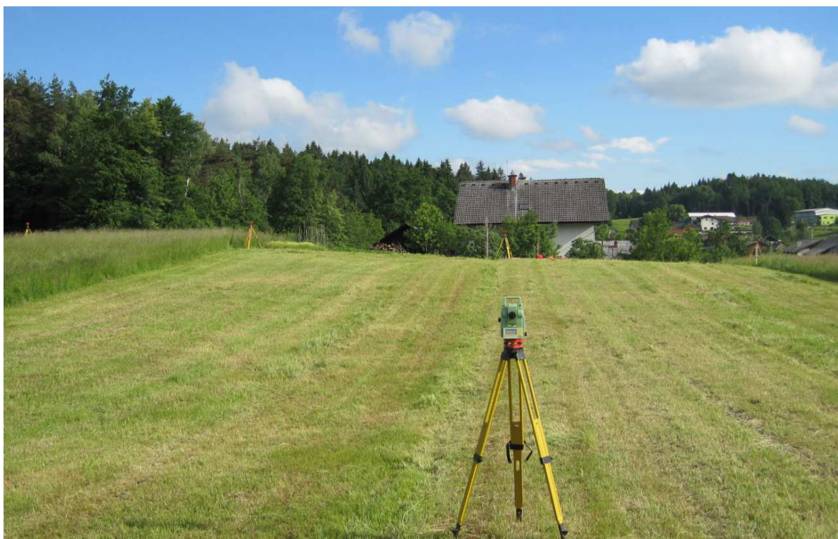
Slika 10: Prikaz postavitve točk in tahimetra na terenu pri opravljanju meritev na razdalji 50m
