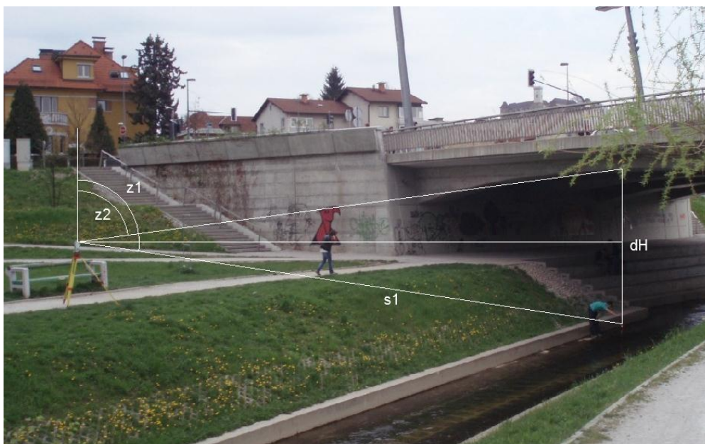
Slika 12: Meritve nedostopne višine
