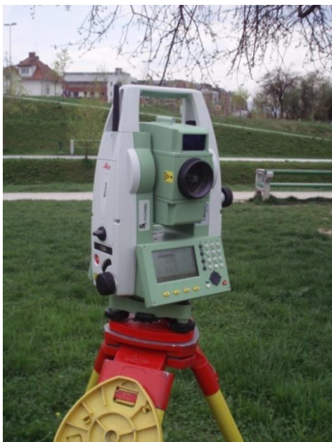
Slika 1: Elektronski tahimeter Leica TS06 Flexline
