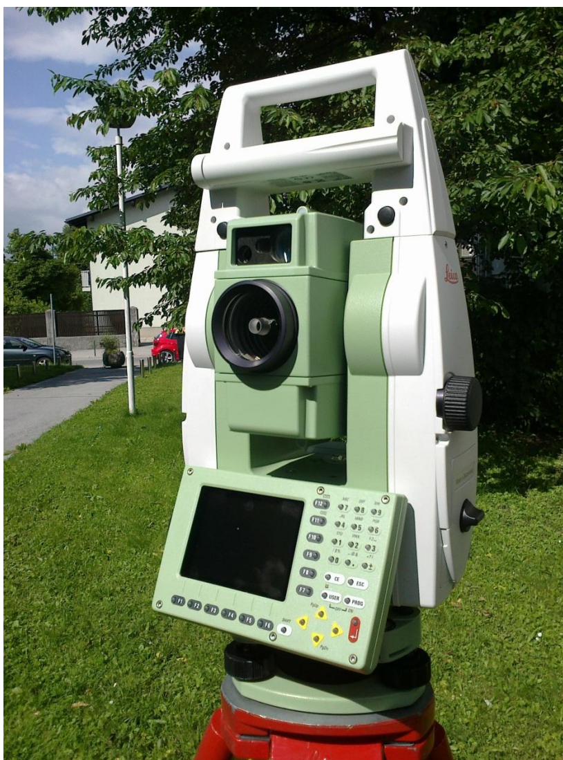
Slika 2: Elektronski tahimeter Leica TCRP 1201+R1000
