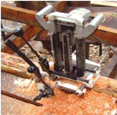
Slika 6: Motorna žaga za izdelovanje utorov (Law, 2010: str. 42)
