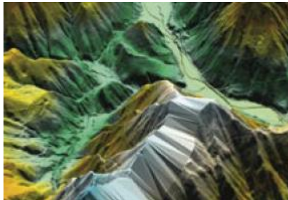
Slika 15c: 3D prikaz območja Idrijskega preloma pri Kapi in Srednji Kanomlji z digitalnim modelom višin ločljivosti 2 m (Gosar, 2007)
