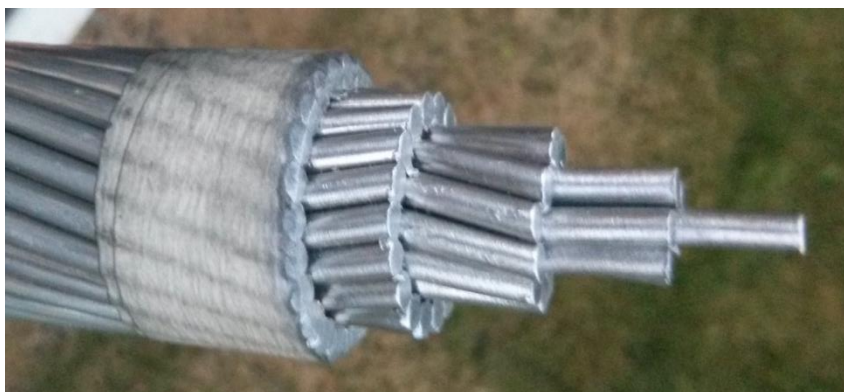
Slika 4: Prerez daljnovodnega vodnika [Inštitut za metalne konstrukcije, 2013]
