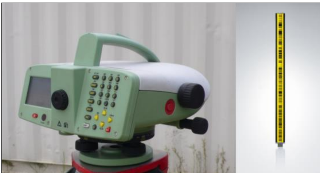
Slika 16: Digitalni nivelir Leica DNA (Geoservis Feb. 2013) in nivelmanska lata s kodno razdelbo ( http://www.leica-geosystems.com/en/DNA-Levelling-staffs_85069.htm Feb. 2013)
