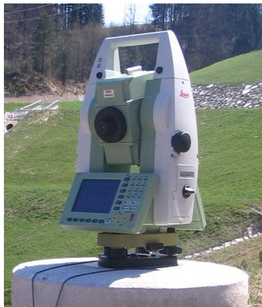
Slika 14: Elektronski tahimeter Leica Geosystems TCRP1201+ R1000
