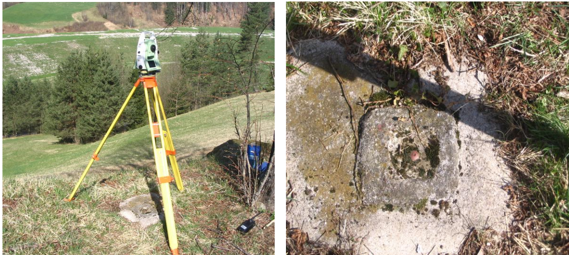
Slika 13: Stabilizacija točke 7-SJ osnovne rudniške mreže
