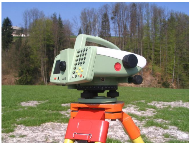
Slika 15: Precizni nivelir Leica DNA03
