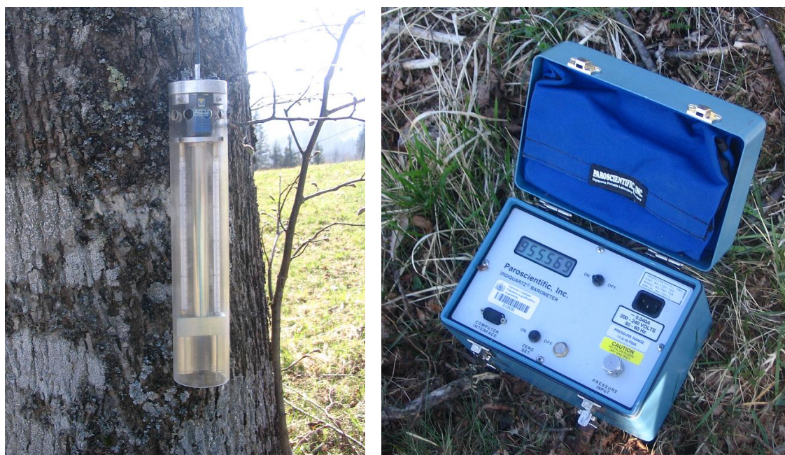
Slika 16: Precizni aspiracijski psihrometer (levo) in digitalni barometer Paroscientifi (desno)
