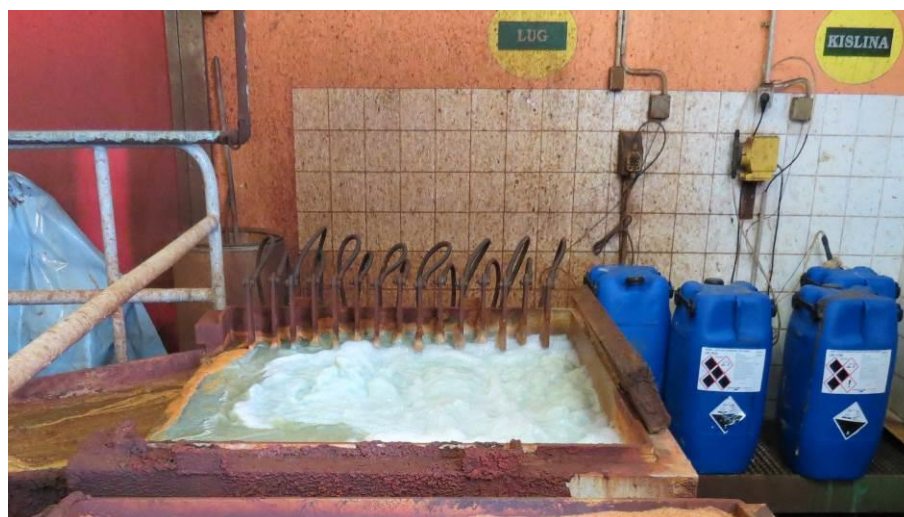
Slika 39: Bazen za reagiranje z elektro flokulacijo in aeracijo (Foto: Matjaž Ozbič)
