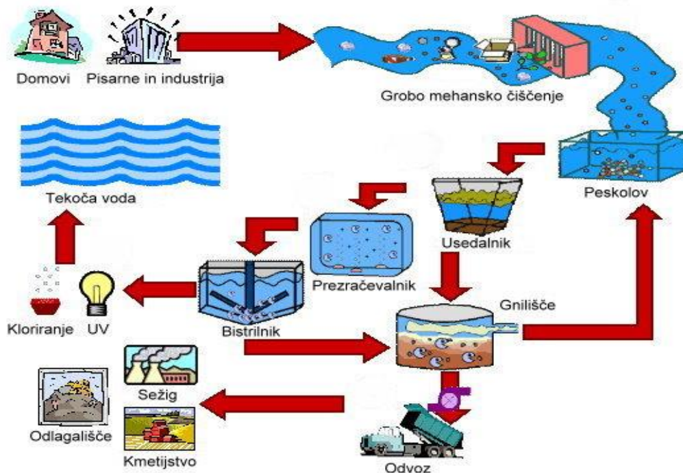
Slika 4: Shematični prikaz poteka umazane odpadne vode do ponovne uporabe in odstranitve odpadnega blata. (www.minet.si)
