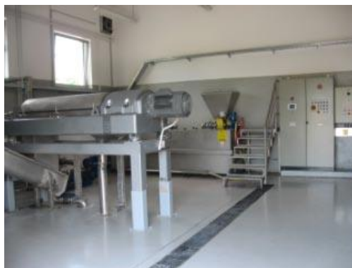
Slika 13: Centrifugalna naprava za sušenje odpadnega blata
