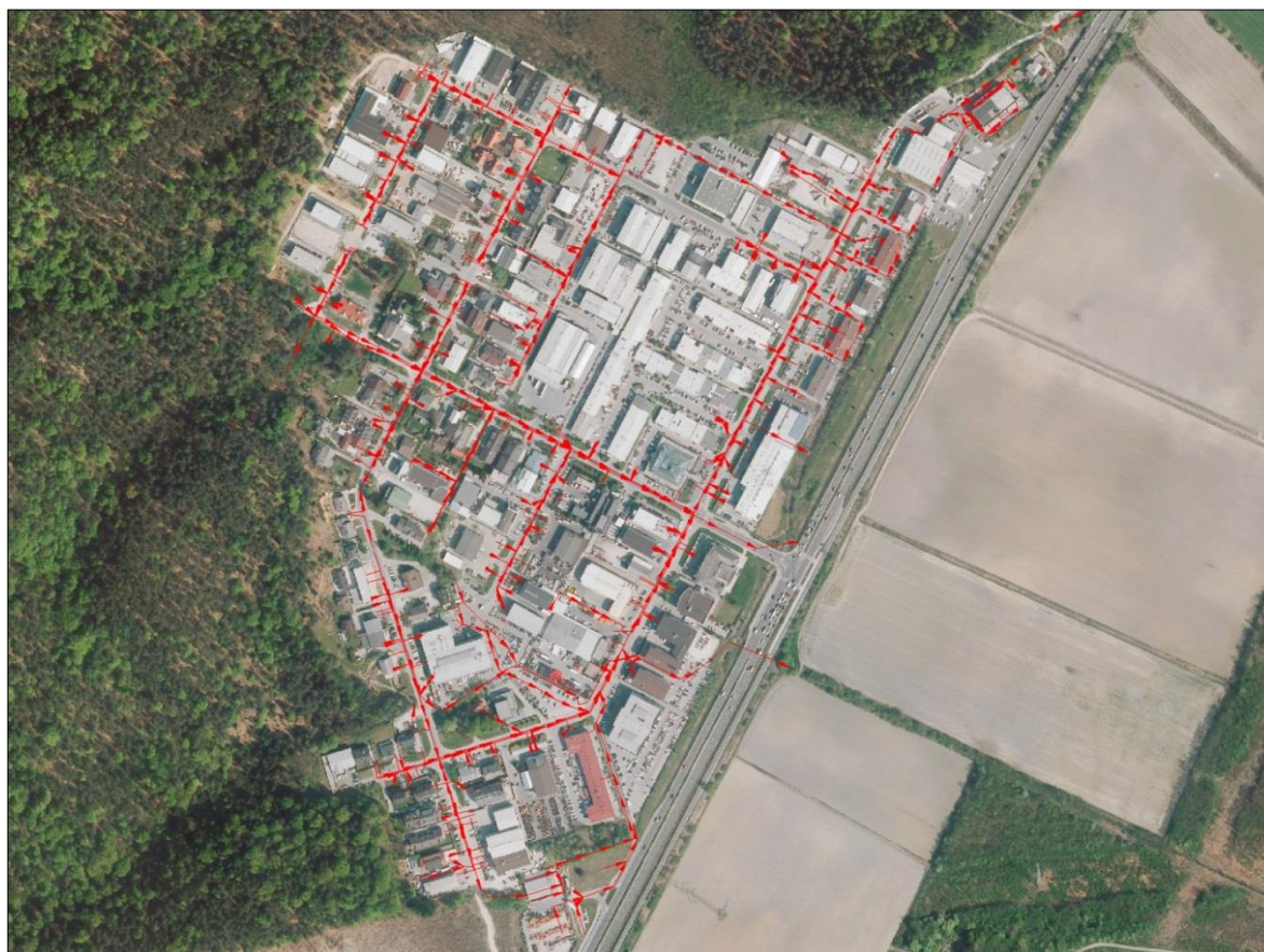
Slika 29: Fekalna kanalizacija na IOC Trzin (JKP Prodnik, 2013č)
