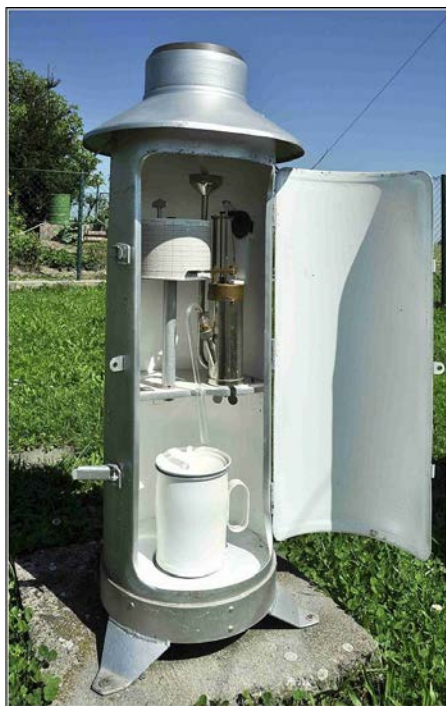
Slika 2: Primer ombrografa z merilnimi inštrumenti, posodo in kolutom za zapis količine padavin (Vir: Počasi-Hrušová, 2013).
