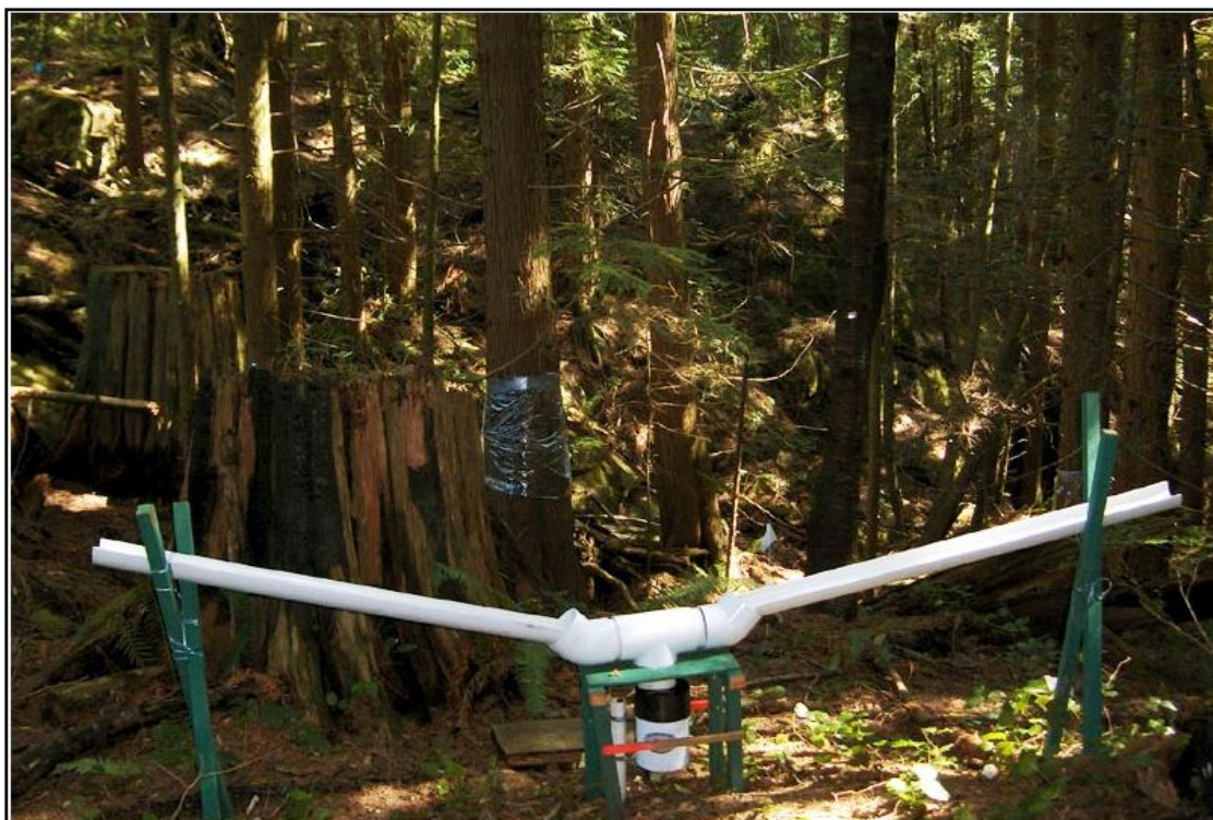
Slika 4: Dve zbirni korita za merjenje prepuščenih padavin, ki sta povezani na zbirno posodo (Vir: SFU, 2013).
