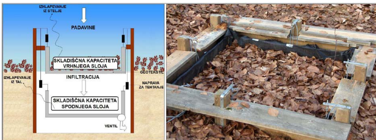
Slika 7: Primer lizimetra za določanje izhlapevanja s stelje (Povzeto po Gerrits, 2010).
