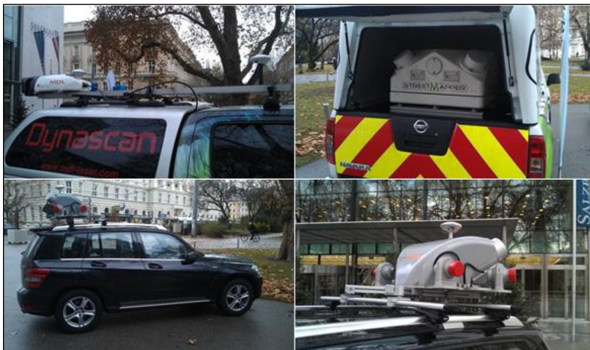
Slika 3: Nabor komercialnih mobilnih laserskih sistemov (RIEGL, Dynascan, StreetMapper), predstavljenih v Salzburgu na konferenci ELMF 2012.
