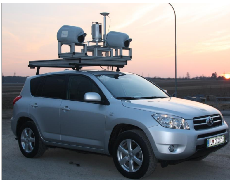
Slika 33: Celotna platforma MLS sistema, konfigurirana na avtomobilu.
