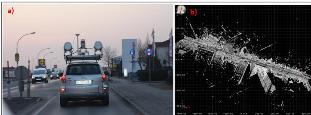
Slika 38: Zajem podatkov na terenu a) in rezultat kot oblak točk b).
