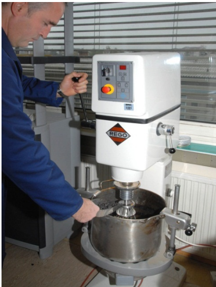
Slika 37: Laboratorijska priprava bitumenizirane zmesi SMA 8 RmB (Lukač, 2011/2012)
