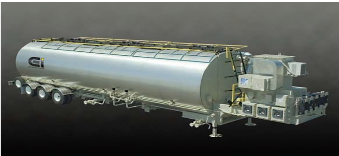
Slika 19: Slika cisterne za gumirani bitumen z mešalom (CEI Enterprises)
