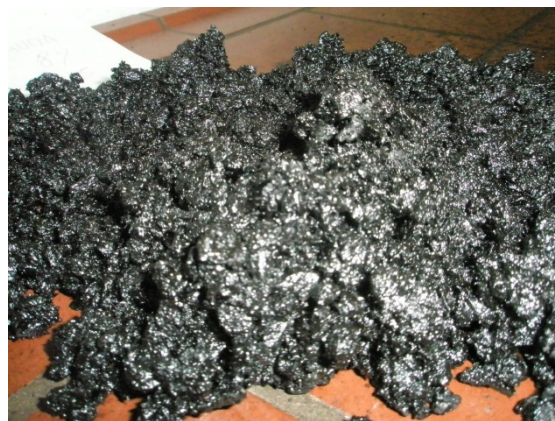
Slika 38: Bitumenizirana zmes SMA 8 z RmB (Lukač, 2011/2012)
