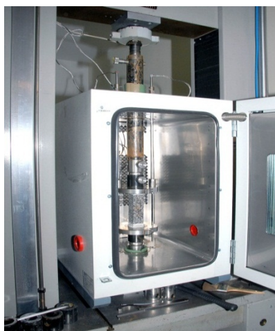
Slika 43: Vpet vzorec v temperaturni komori pred začetkom preiskave (Lukač, 2011/2012)
