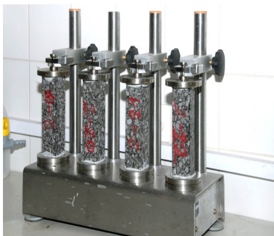
Slika 42: Pripravljeni vzorci za preiskavo odpornosti bitumenizirane zmesi proti nizkim temperaturam (Lukač, 2011/2012)
