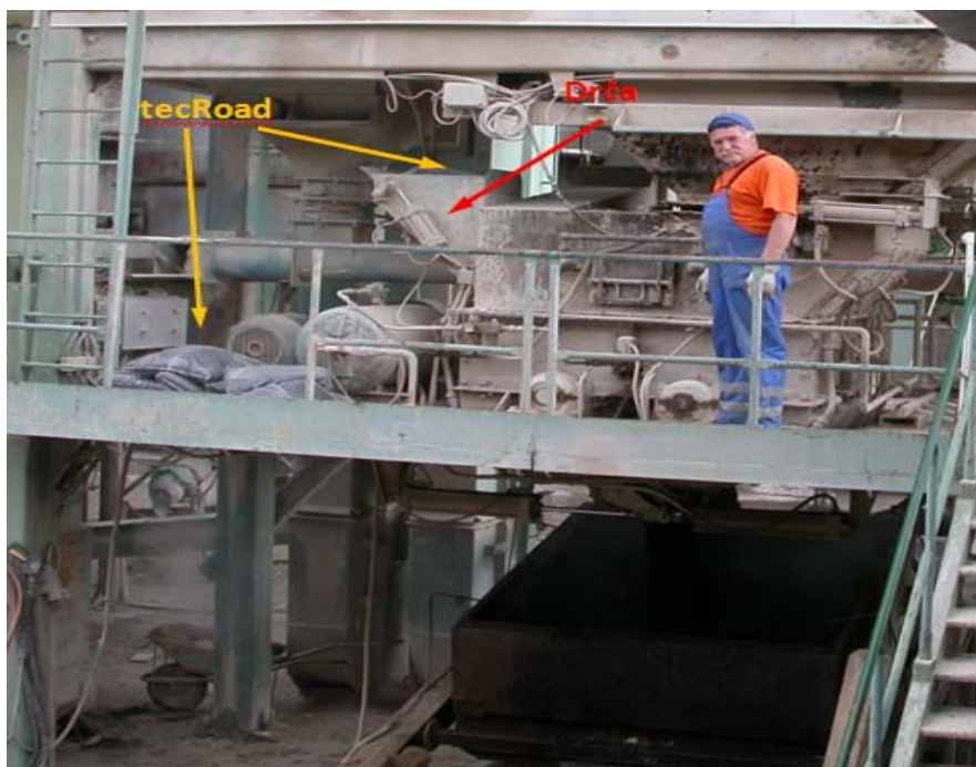
Slika 21: Dodajanje bitumenskega granulata gume preko drče direktno v mešalnik (Pavšič, idr., 2010)
