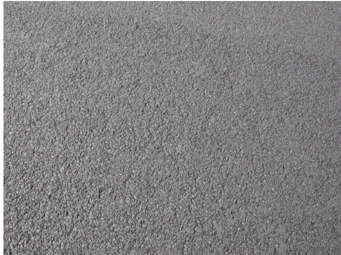
Slika 24: Z gumo modificirana bitumenizirana zmes AC8 surf B70/100 A3 z dodatkom bitumenskega granulata gume (Pavšič, idr., 2010)
