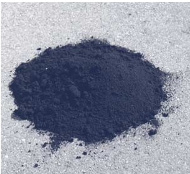
Slika 20: Bitumenizirani granulat gume tecroad (Rubbertec)
