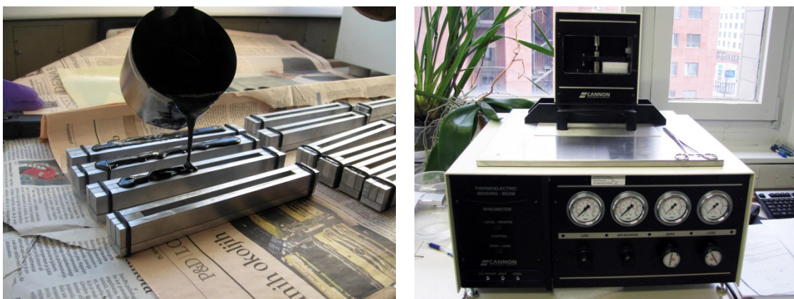
Slika 33: Priprava vzorcev za preiskavo z BBR in slika 34: Bending beam reometer-BBR (Lukač, 2011/2012)
