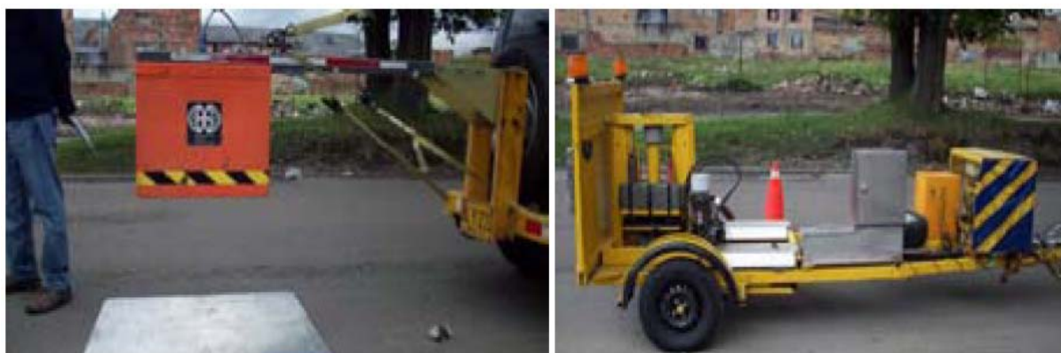
Slika 53: Georadar in udarni deflektometer, uporabljena pri raziskavi (Arguelles, idr., 2009)
