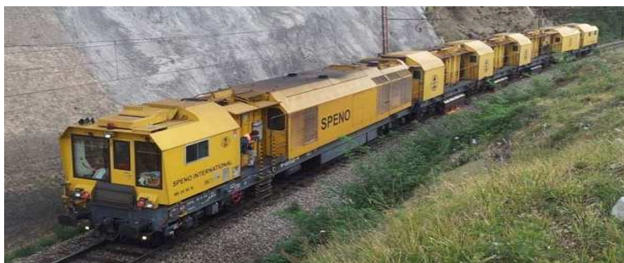
Slika 43: Brusilni vlak Speno RR24M14 med procesom brušenja tirnic
