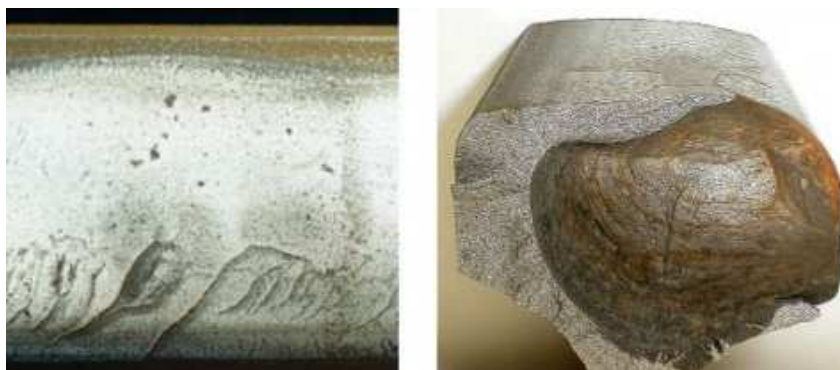
Slika 30: »Head Check« napake na robu vozne površine (levo), prečni zlom v glavi tirnice, ki izhaja iz napak »Head Check« (desno)
