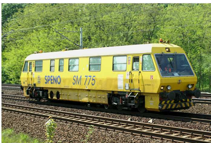
Slika 38: Merilni vlak SPENO SM 775
