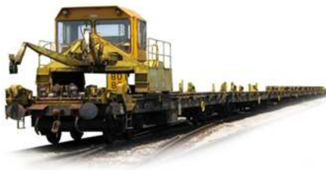
Slika 12: Vlak Robel 40.61-Silad za prevoz tirnic dolžine do 120 m.
