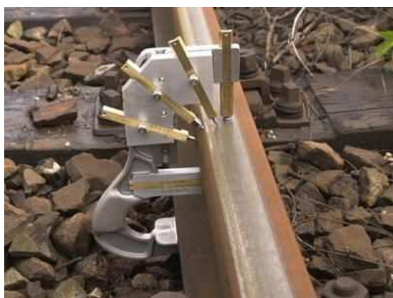
Slika 37: Naprava za ročno merjenje obrabe tirnice
