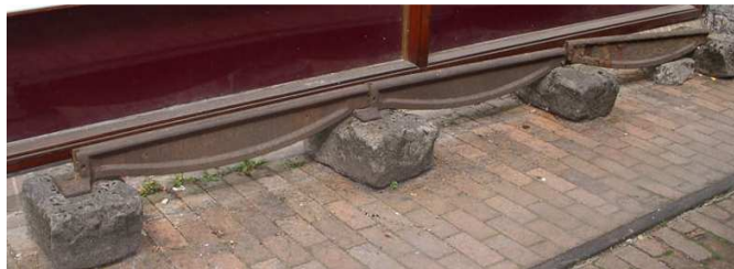
Slika 2: Tirnica iz konca 18. stoletja z vmesno razširitvijo
