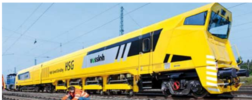
Slika 46: Brusilni vlak podjetja Vossloh za visokohitrostno brušenje
