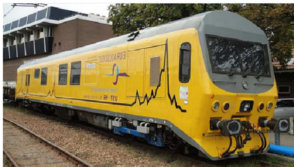
Slika 40: Ultrazvočni merilni vlak UST 96
