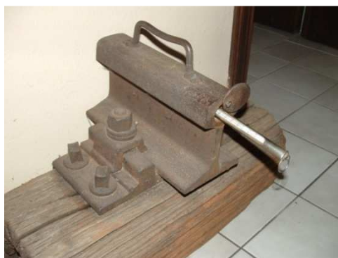
Slika 77: Merjenje temperature v tirnici
