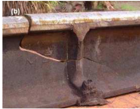
Slika 92: Horizontalni zlom, ki izvira iz srednjega dela (vratu) AT-zvara
