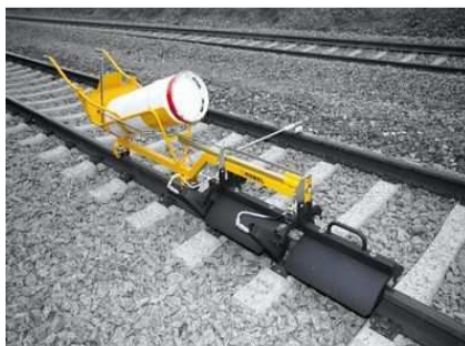
Slika 80: Naprava za segrevanje tirnic
