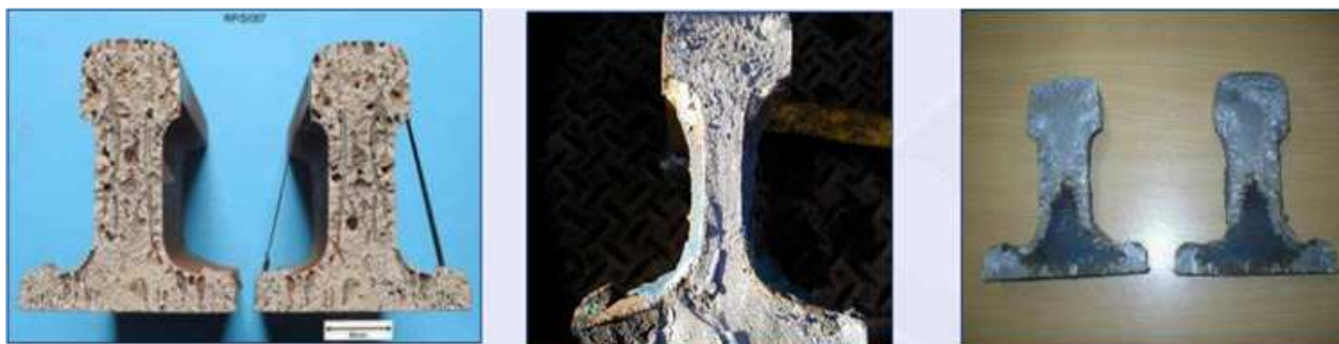
Slika 90: Najpogostejše napake v AT-zvarih, in sicer od leve proti desni: poroznost, nepopolno taljenje, krčenje zvara
