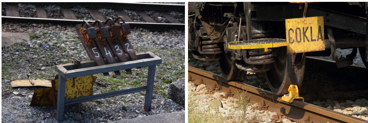
Slika 9: Prostor za hrambo cokel (levo), podstavljena cokla pod kolo (desno) (Vir: fotografiranje na ranžirni postaji Zalog dne: 12.1.2013)
