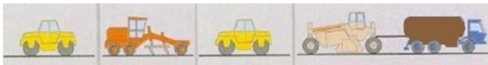
Slika 22: Reciklažni niz pri cementni stabilizaciji, ko v reciklator dovajamo cementno pasto
