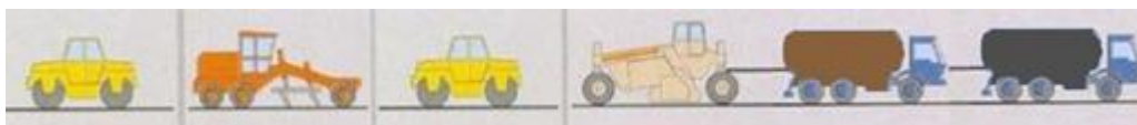
Slika 24: Reciklažni niz pri izvedbi s penjenim bitumnom, kjer cement dodajamo v obliki cementne paste
