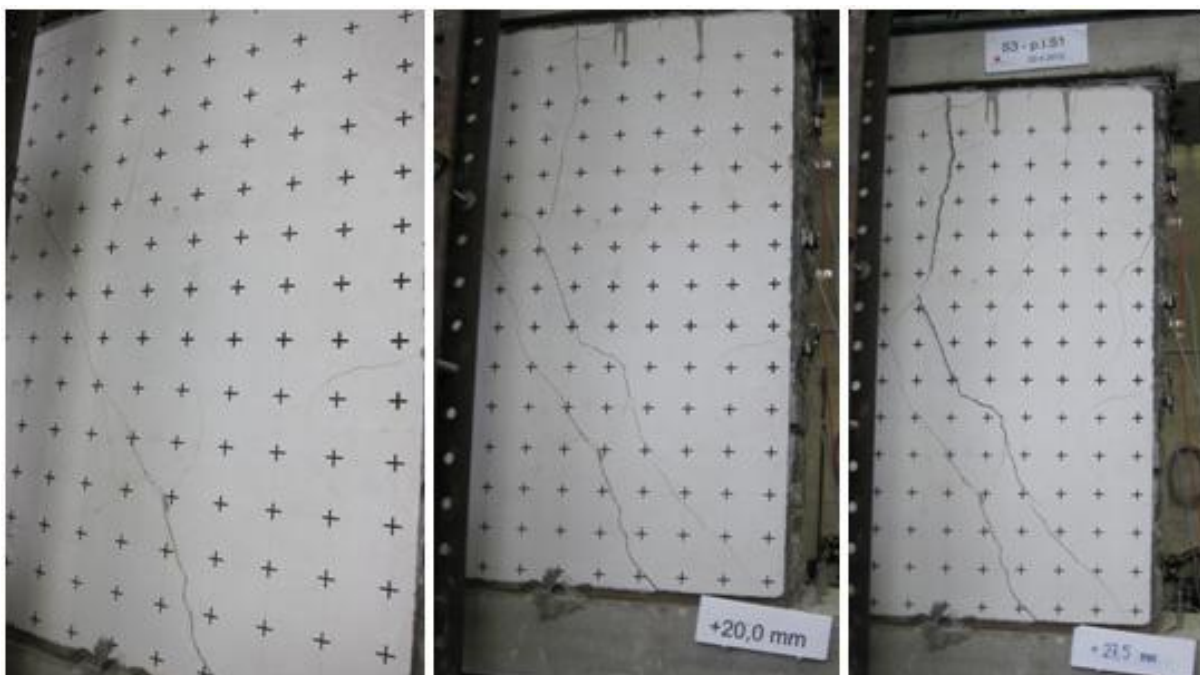
Slika 84: Širjenje razpok na ometu Zidu 2
