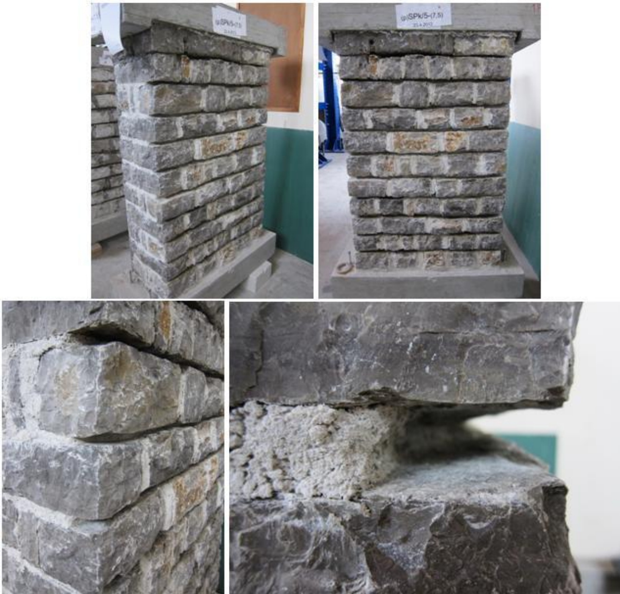
Slika 105: Spojnice pripravljene na vgraditev vrvic
