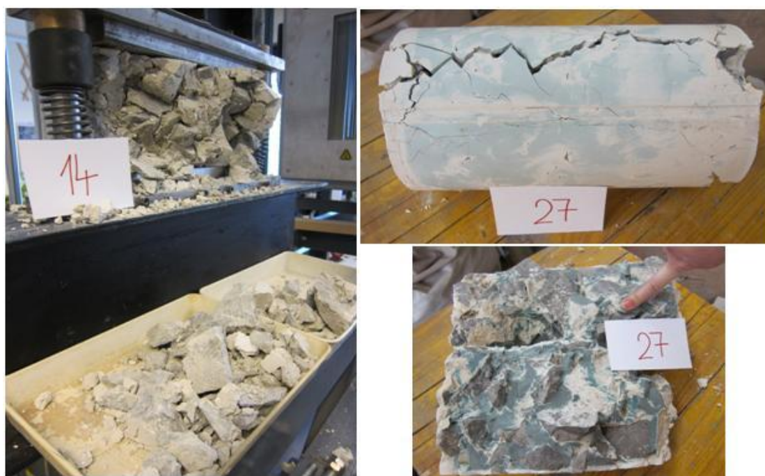
Slika 54: Primer porušitve valja z injekcijsko mešanico C (preizkušanec 14) ter injekcijsko mešanico B (preizkušanec 27)
