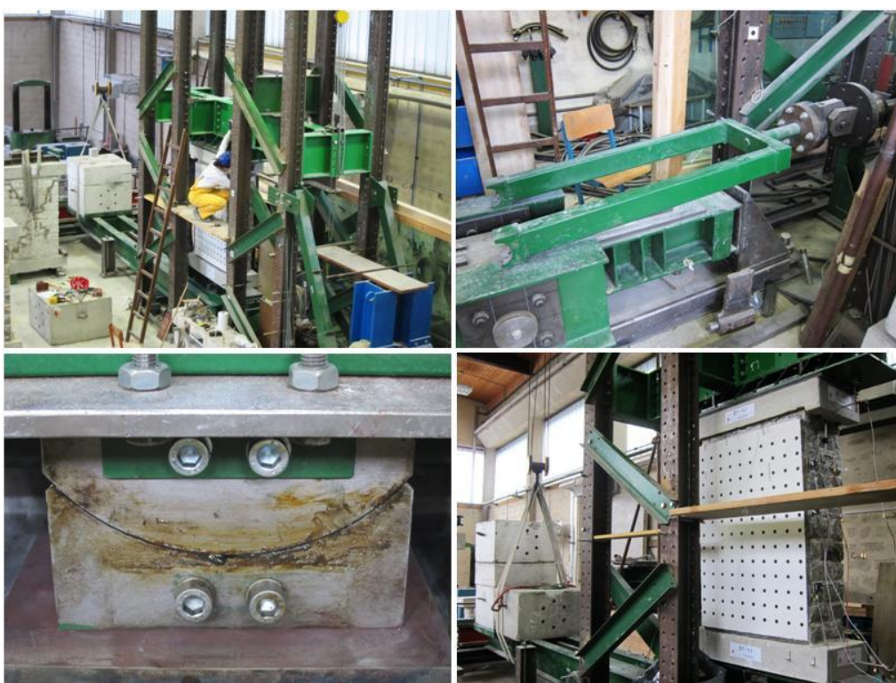
Slika 108: Naprava za strižne preizkuse
