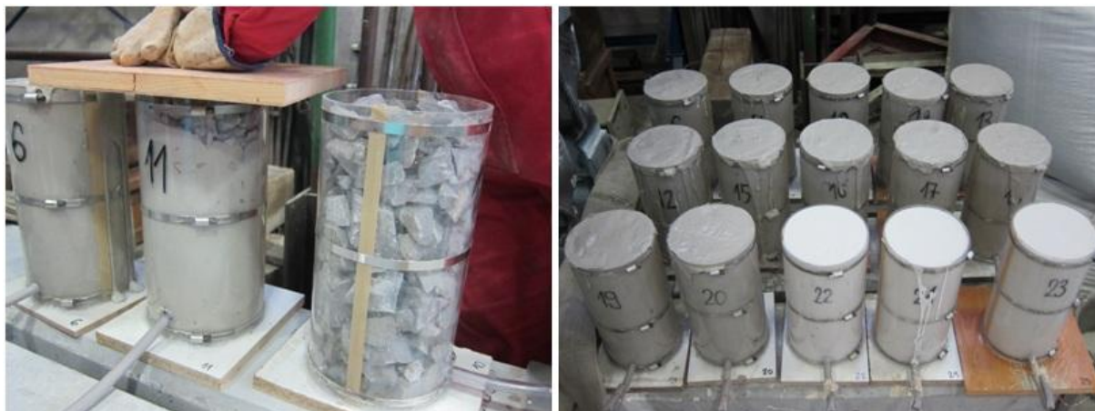
Slika 42: Injektiranje valjev z injekcijsko mešanico C
