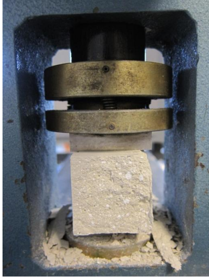
Slika 30: Preizkus tlačne trdnosti
