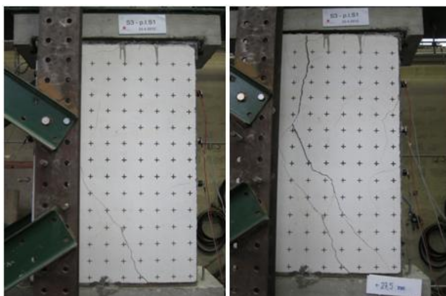
Slika 112: Začetna in končna razpokanost ometa injektiranega in dodatno utrjenega zidu
