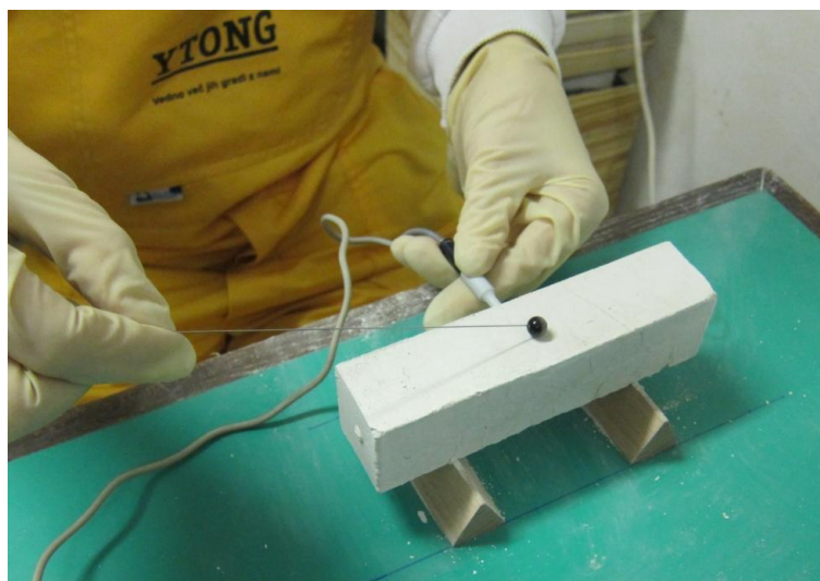
Slika 33: Meritev dinamičnega modula elastičnosti
