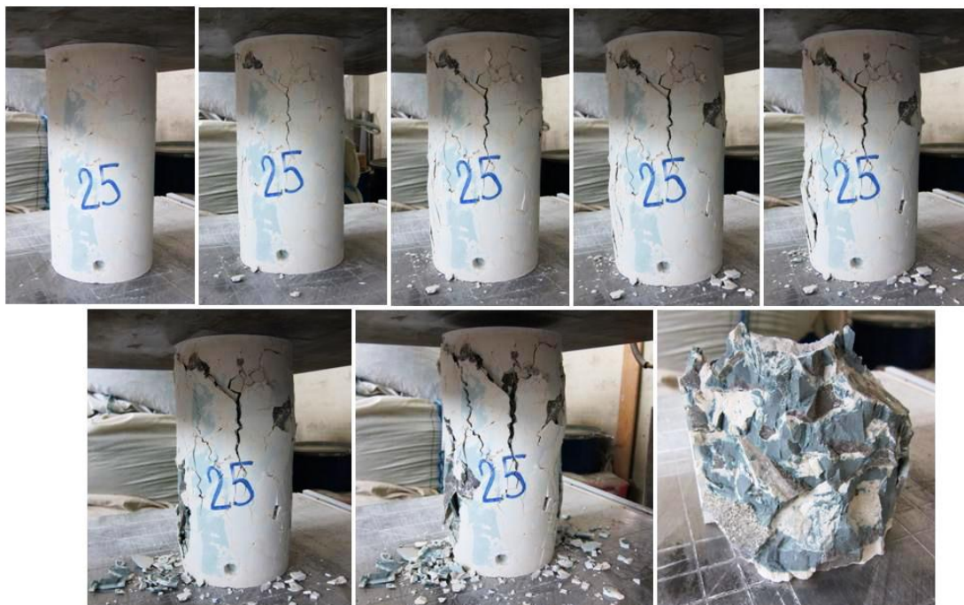
Slika 56: Obnašanje valja pod tlakom iz injekcijske mešanice B
