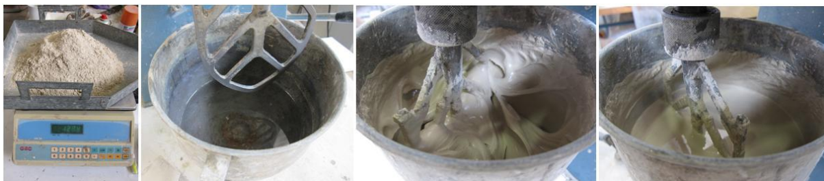
Slika 34: Postopek priprave injekcijske mešanice A
