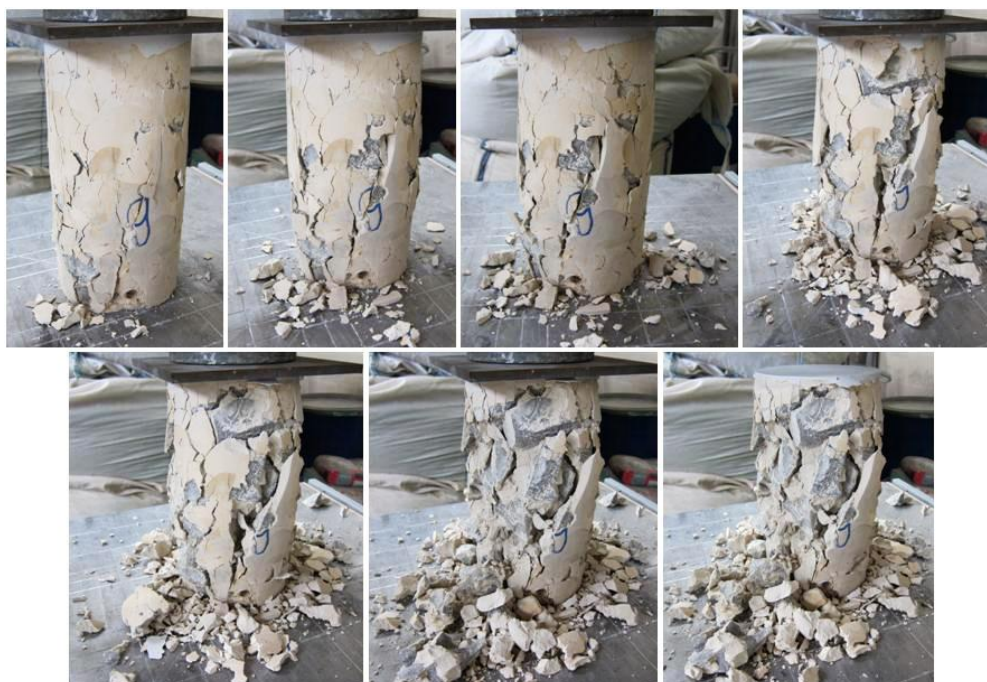
Slika 55: Obnašanje valja pod tlakom iz injekcijske mešanice A
