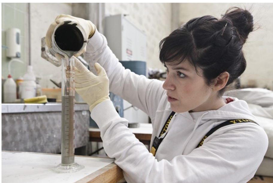
Slika 46: Pripravljanje testa segregacije vode
