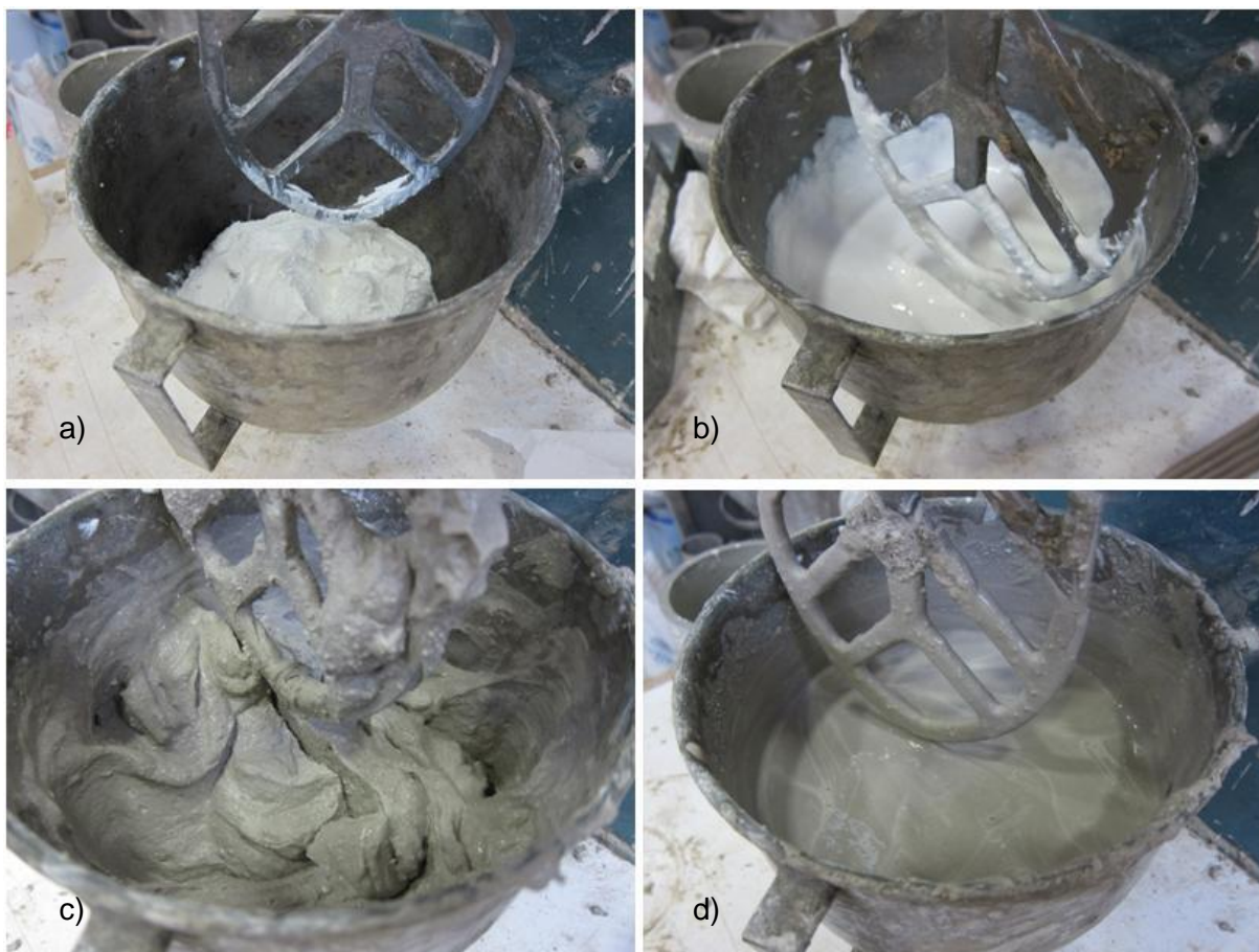
Slika 36: Priprava mešanice: a) Apneno testo b) Apneno testo z dodano vodo c) Mešanica z dodano apnenčevo moko in tufom d) Z dodanim hiperplastifikatorjem
