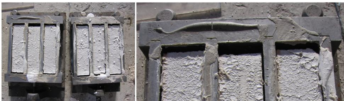
Slika 50: Izrazito krčenje injekcijske mešanice C
