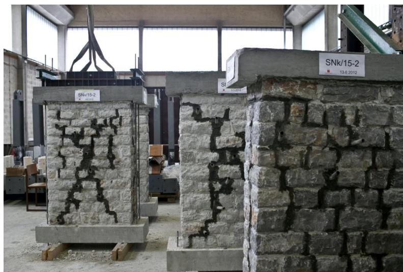
Slika 15: Preizkušanci po linijskem injektiranju
