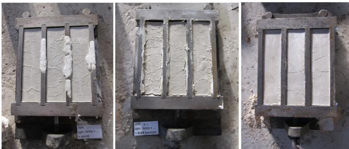
Slika 51: Primerjava krčenja injekcijskih mešanice C1 z apnim testom in peskom, C2 z apnim testom in bentonitom ter C3 z apnom v prahu
