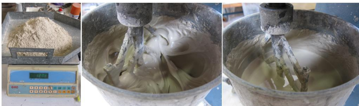
Slika 91: Pripravljanje injekcijske mešanice A
