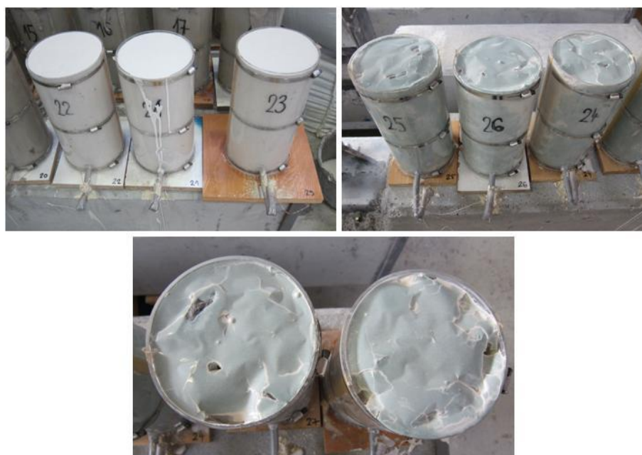
Slika 41: Primerjava valjev injektiranih z injekcijsko mešanico B takoj po injektiranju in po preteku 48 ur
