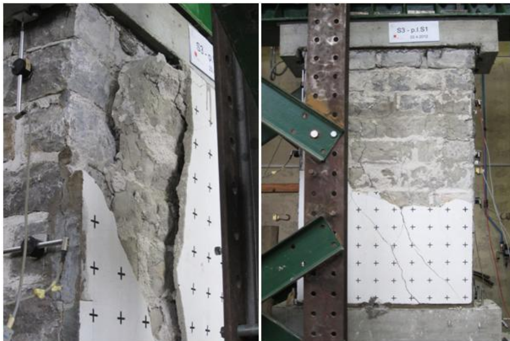
Slika 114: Delno porušen omet
