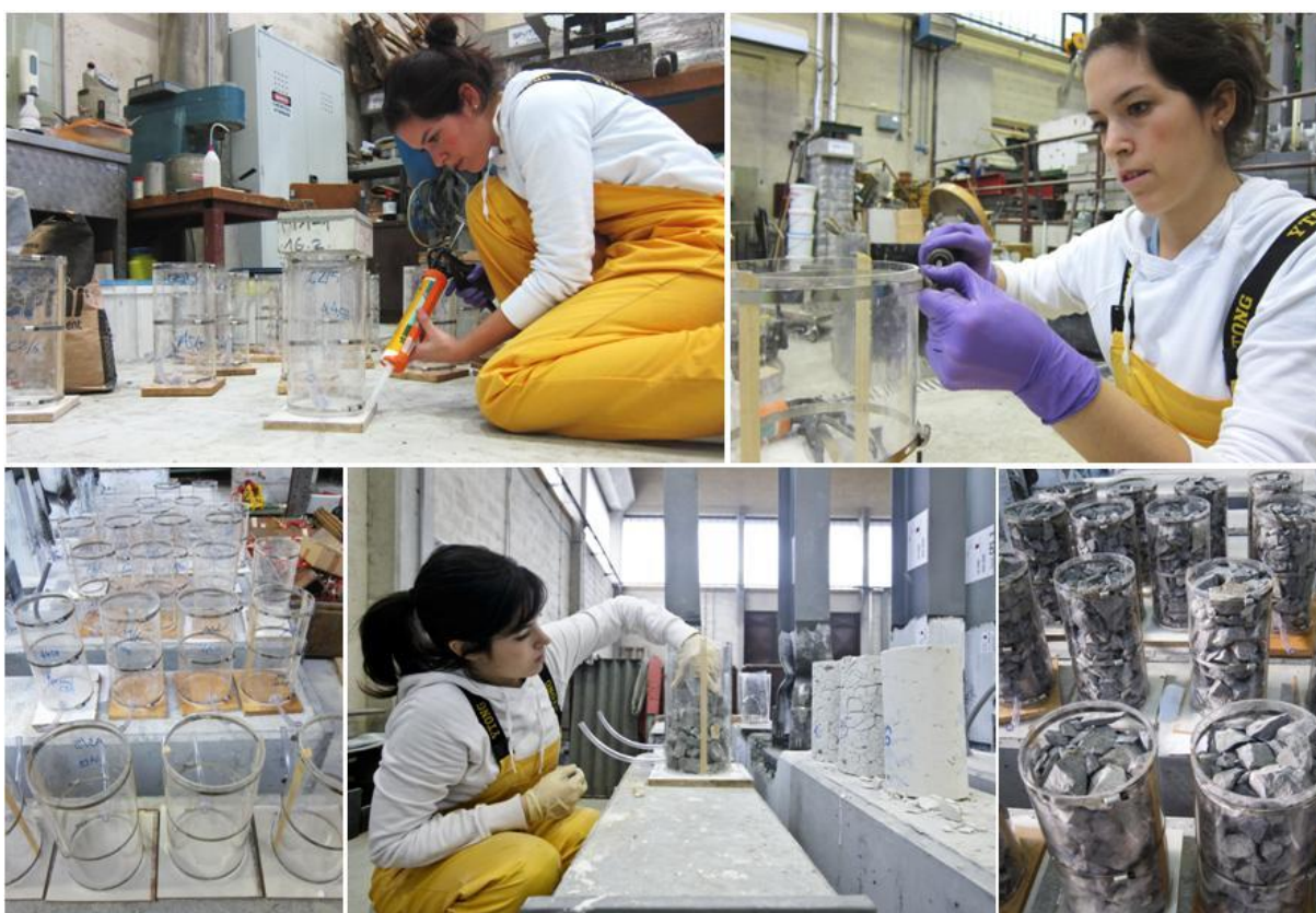
Slika 90: Pripravljanje valjastih preizkušancev
