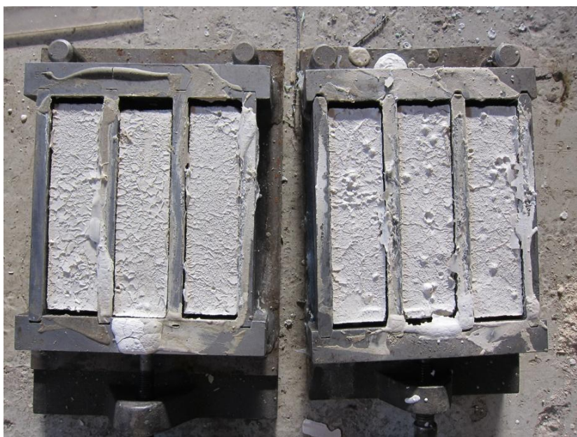
Slika 44: Izrazito krčenje prizem iz injekcijske mešanice C
