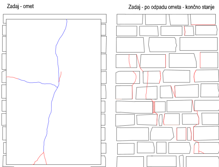
Slika 83: Razpoke na zadnjem delu Zidu1, z ometom in brez
