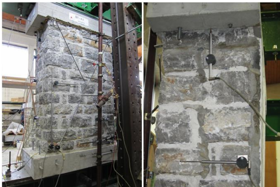
Slika 109: Zidovi opremljeni z induktivnimi merilci
