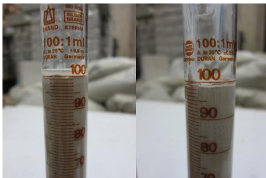
Slika 37: Primerjava izločanja vode pri dveh različnih mešanicah
