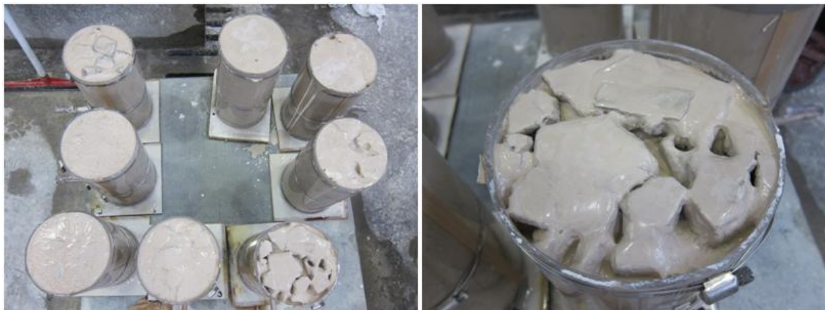
Slika 39: Sesedanje injekcijske mešanice
