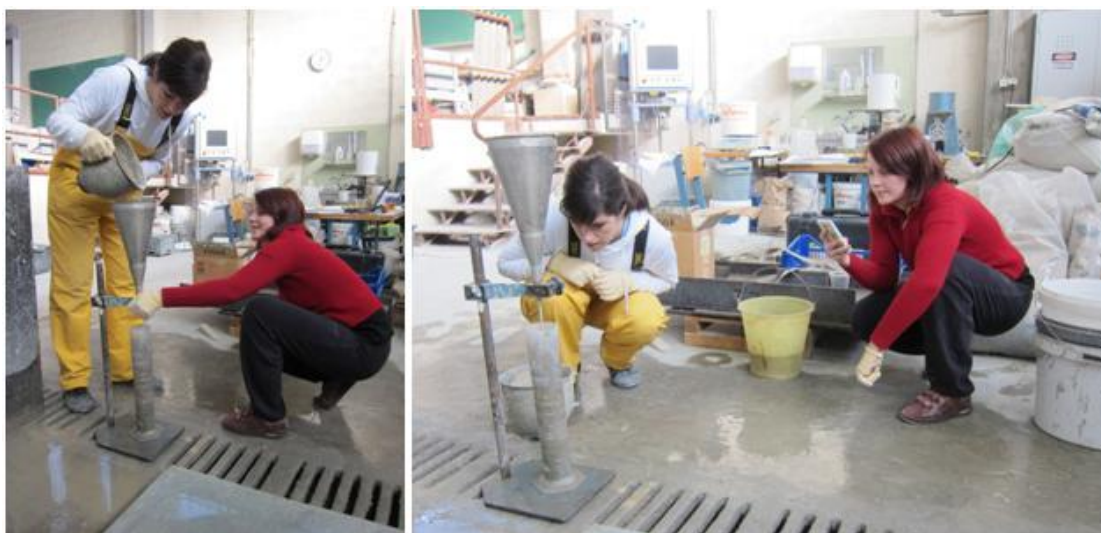
Slika 22: Meritev pretočnosti injekcijske mešanice
