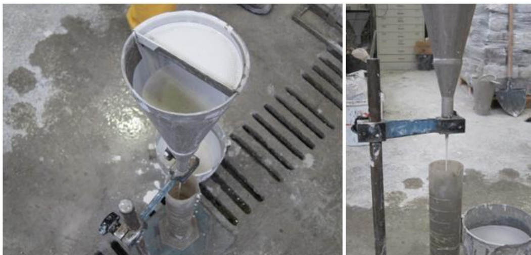
Slika 35: Test pretočnosti injekcijske mešanice B
