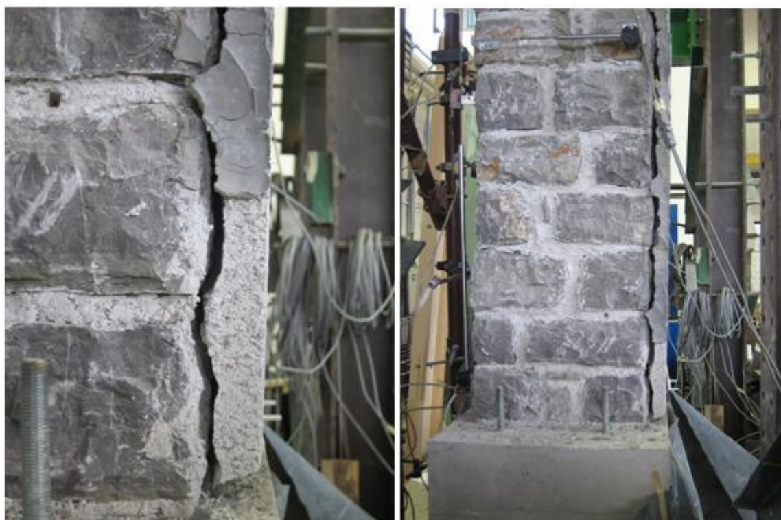
Slika 79: Odstopanje ometa od Zidu 1
