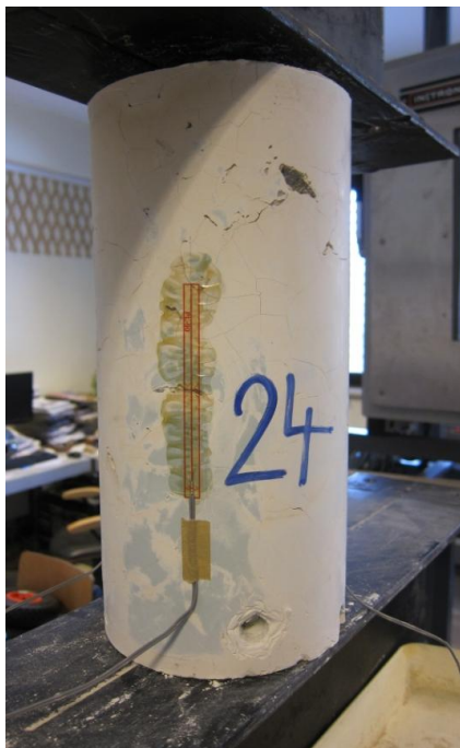
Slika 32: Valj opremljen z merilnimi lističi
