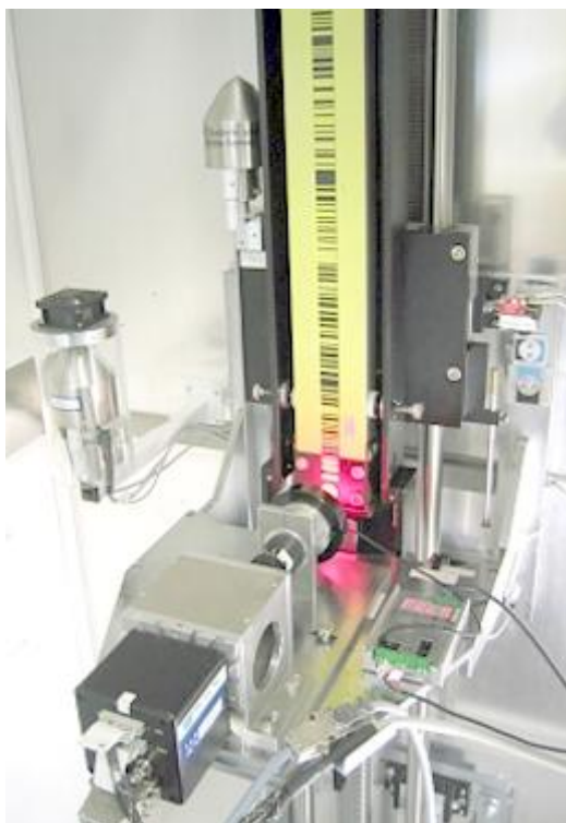
Slika 28: Zajem elementov razdelbe late na vertikalnem in horizontalnem komparatorju na TU München
