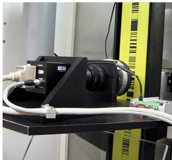
Slika 29: Lasersko interferometrični sistem in CCD kamera vertikalnega komparatorja Geodetskega zavoda Nordrhein-Westfalen (LVerMA NRW)
