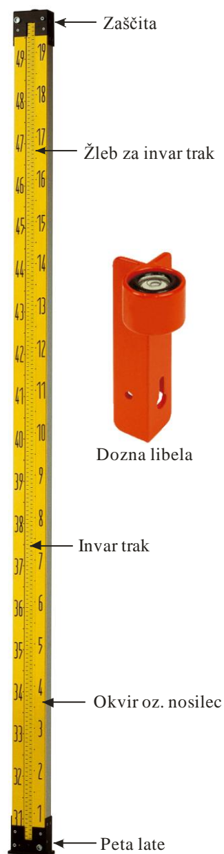
Slika 12: Zgradba preciznih invar nivelmanskih lat
