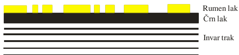
Slika 14: Profil razdelbe dobljene z interferometrično metodo graviranja
