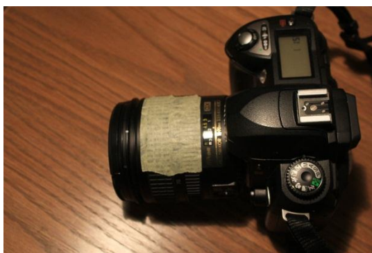
Slika 5: Fiksiranje goriščne razdalje pri zoom objektivih z lepilnim trakom
