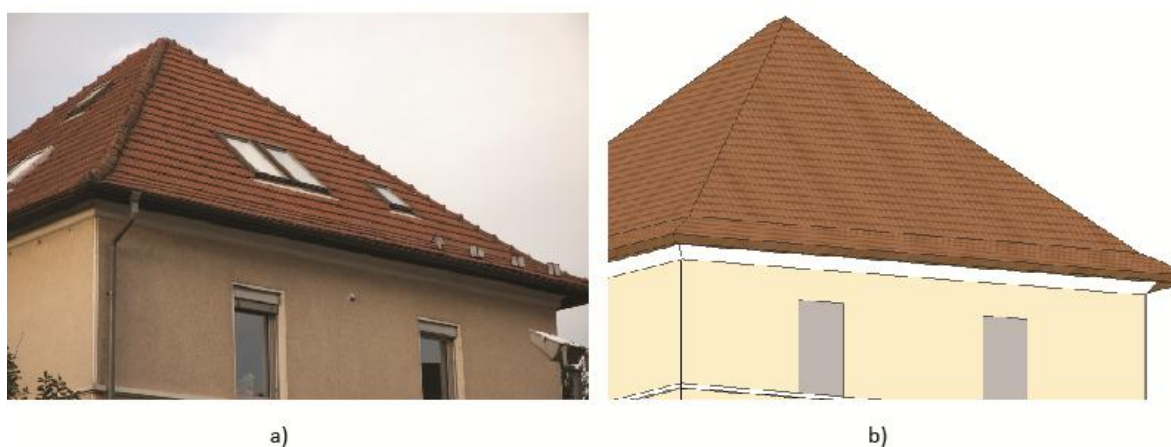
Slika 67: Primerjava strehe: (a) dejansko stanje (b) ploskovni model
