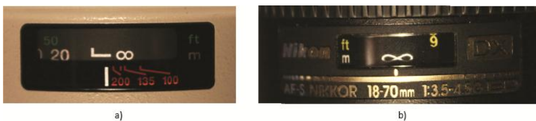
Slika 13: Nastavitev na neskončnost: (a) primer Canonovega objektivu, (b) primer Nikonovega objektivu
