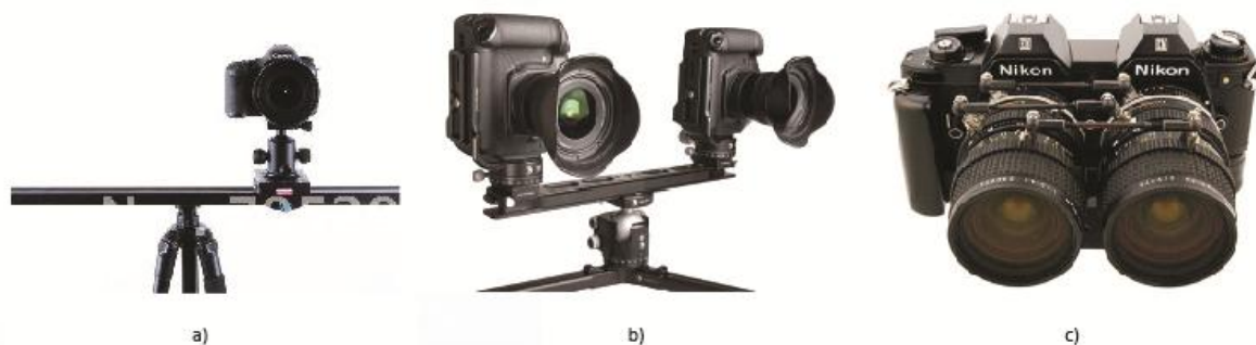
Slika 26: (a) Fotoaparat na drsnem stativu (vir: Aliexpress, 2013), (b) kombinacija dveh fotoaparata na drsnem stativu (vir: Short Course, 2013), (c) stereo fotoaparat (vir: New Zealand Stereoscopic Society, 2013)
