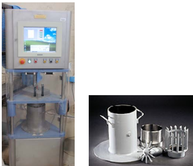
Slika 5: ConTec Viscometer 5: (levo) slika reometra v Konstrukcijsko – prometnem laboratoriju na FGG, (desno) slika posameznih sestavnih delov reometra [16]
