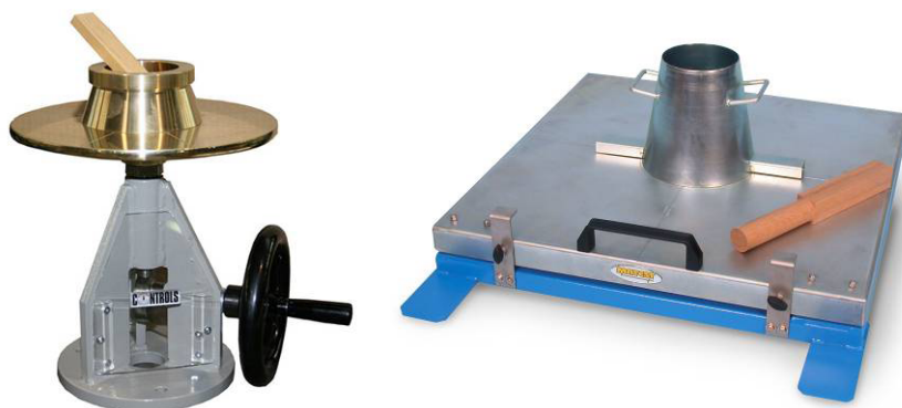
Slika 9: Stresalni mizi za preizkus z razlezom za malte (levo) in betone (desno) [25, 26]
