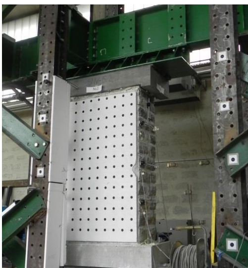
Slika 12: a) Primer preizkušanca, opremljenega z detajlnimi točkami, na stebrih v okolici preizkušanca so vidne tudi oslonilne točke in b) primer oslonilne točke
