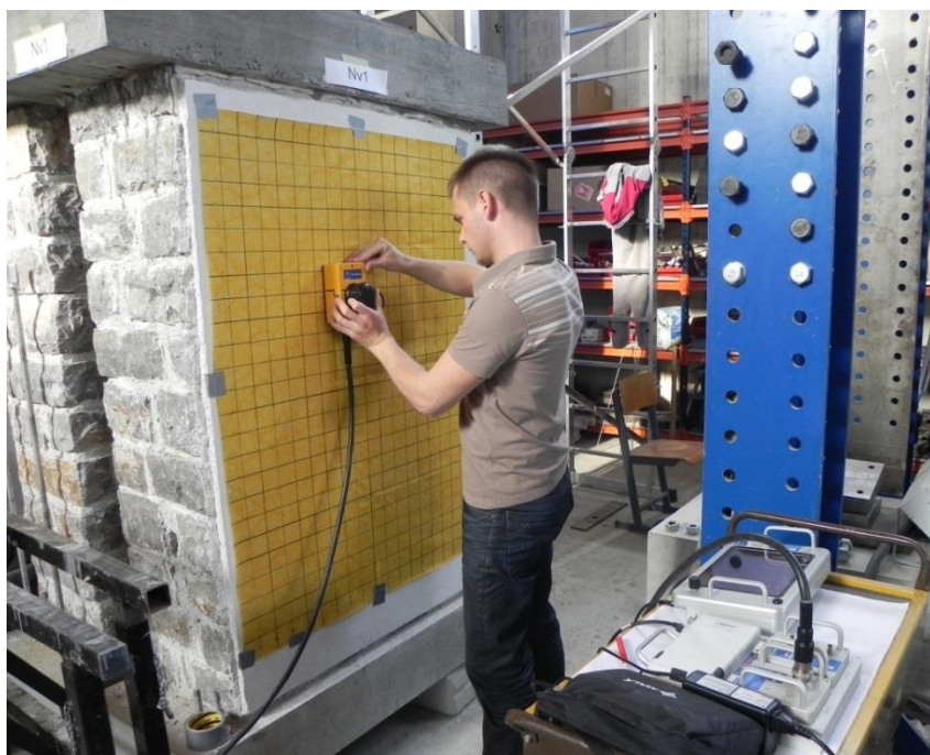
Slika 35: Izvajanje georadarskih meritev
