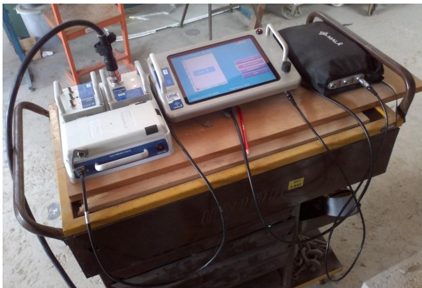
Slika 32: Generator in sprejemnik elektromagnetnih impulzov (MALÅ ProEx) ter krmilno – procesna enota (MALÅ ramac monitor XV11)
