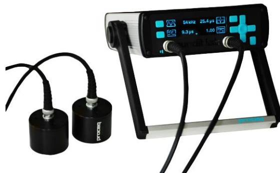
Slika 5: Merilna oprema za izvajanje metode z ultrazvokom (Proceq ultrasonic-pulse velocity, 2012)
