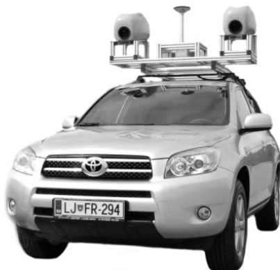
Slika 35: Cestno mobilni kartirni sistem WideoCar 3
