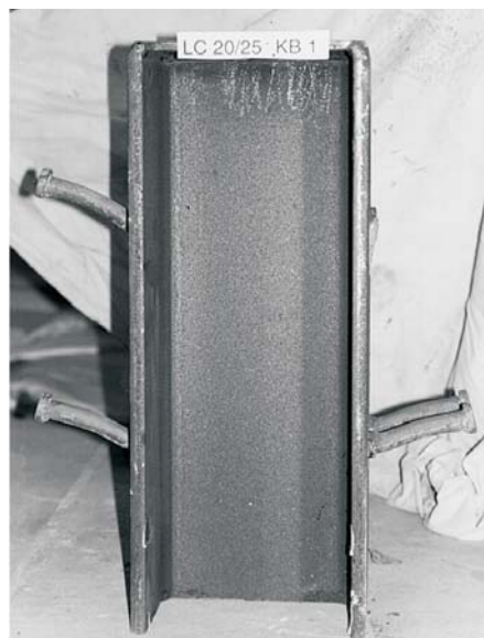
Slika 2.9: (a) Preizkušanelec pred testiranjem. (b) Mozniki po testiranju. (Faust, 1996)
