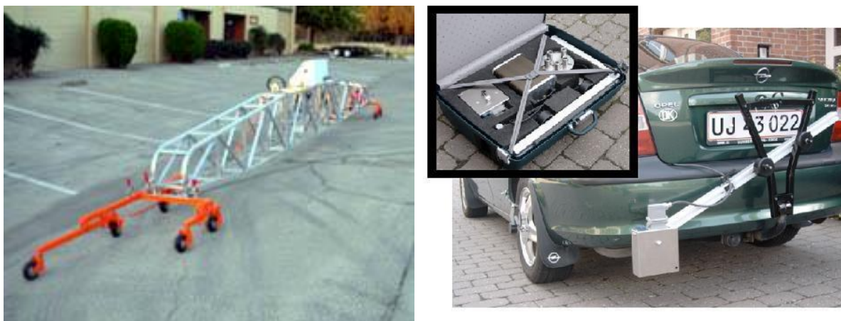
Slika 15: Mehanični profilograf (levo) in laser (desno) (Google, 2012)
