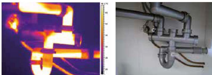
Slika 15: Detekcija nepravilnosti pri ceveh (FLIR, 2011)
