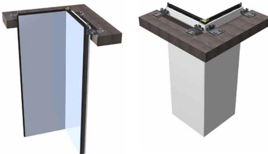
Slika 37: 3D prikaz stika dveh Qbiss Air panelov v vogalu fasade navznoter (Tehnični list Qbiss Air, 2011)
