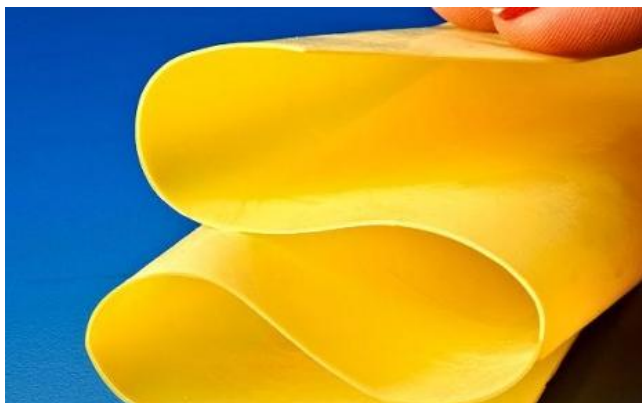
Slika 99: Poliamidni aerogel, ki ga je razvila NASA (Gizmag, 2012)
