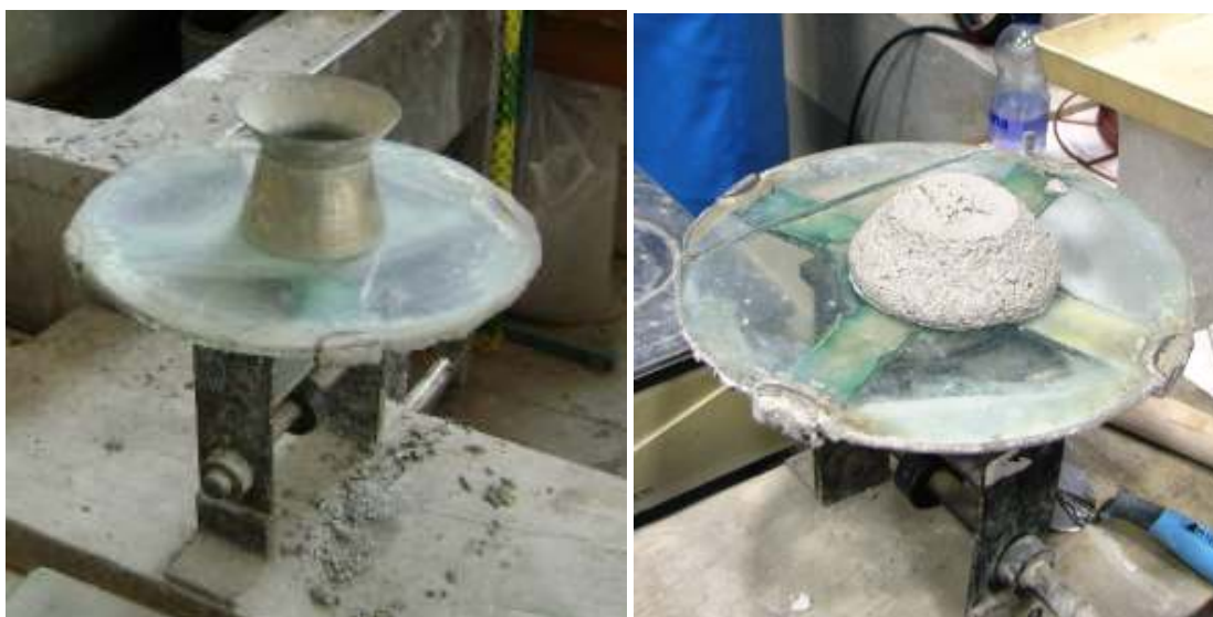
Slika 35: Stresalna mizica za določanje razleza malte
