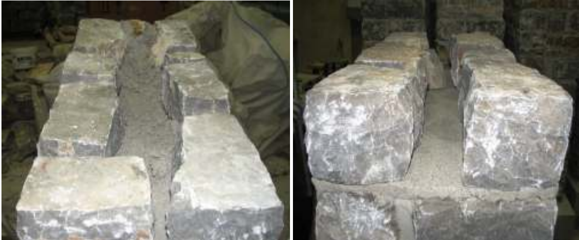
Slika 29: Struktura zidu s smerniško zidarsko zvezo
