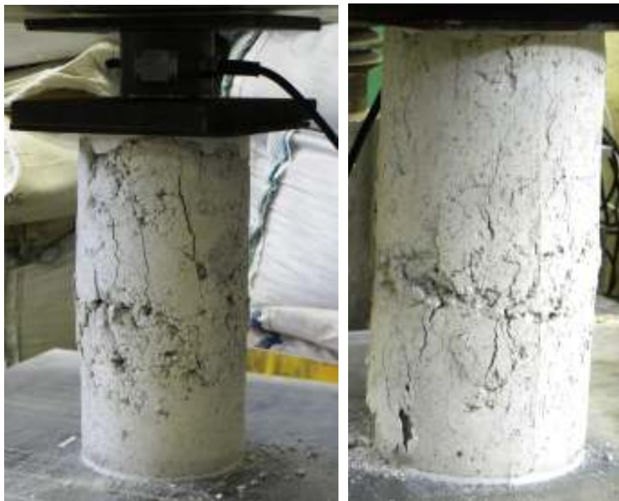
Slika 41: Tlačna preiskava jedra zidu
