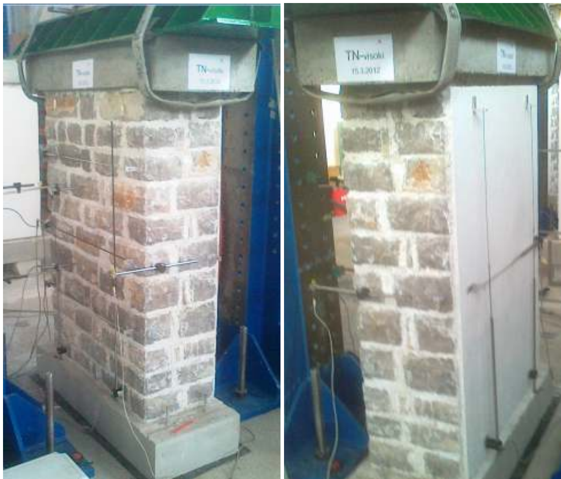
Slika 50: Zid pred obremenjevanjem in merilna mesta deformacij
