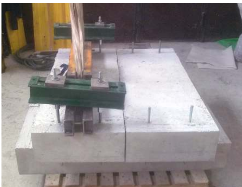
Slika 23: Nosilec zidka vpet v jeklen jarem za transport z mostnim žerjavom
