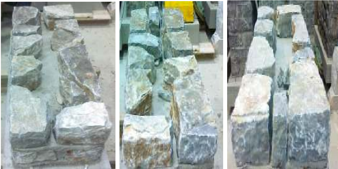
Slika 30: Skladi zidka pozidani s smerniško zidarsko zvezo
