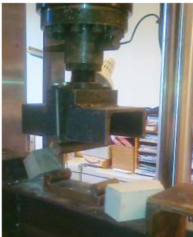
Slika 40: Preiskava upogibne trdnosti kamna
