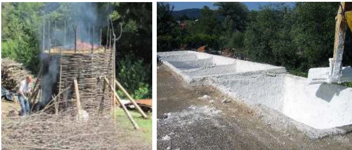
Slika 19: Levo: peč za žganje apna (apnenica), desno: jama za gašeno apno (apnica)
