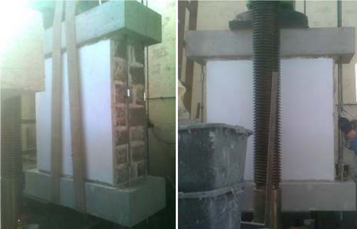
Slika 47: Nameščanje zidka v stiskalnico kapacitete 5000 kN
