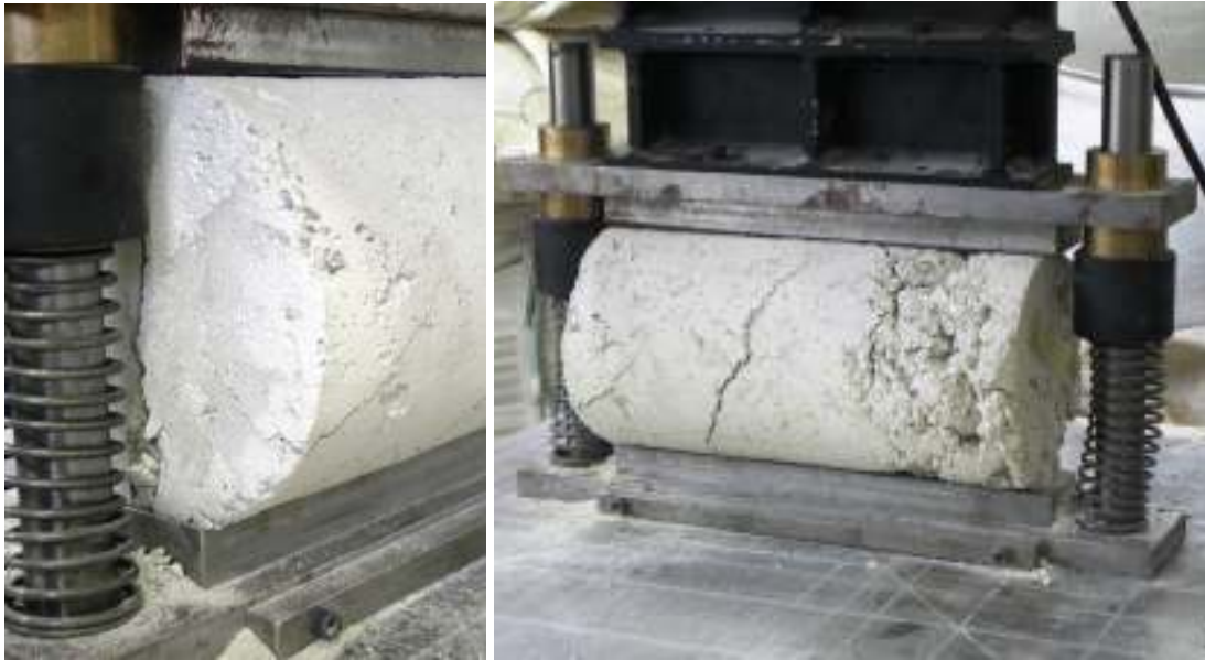
Slika 42: Preiskava cepilne natezne trdnosti jedra zidu
