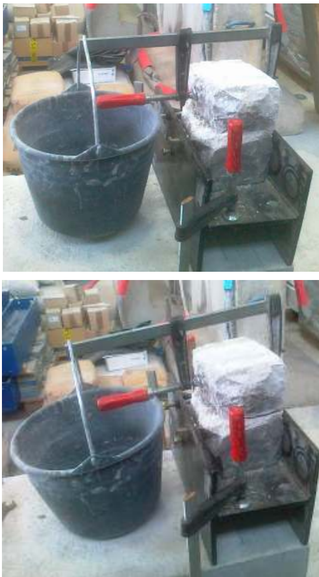
Slika 44: Preizkus »Bond wrench« v laboratoriju
