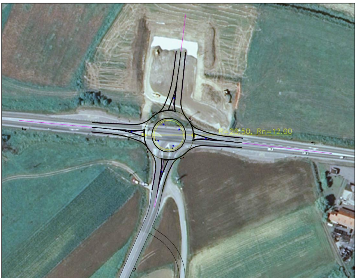
Slika 21: Rekonstrukcija nevarnega mesta ID 1019 Pesnica – Lenart (opomba: Idejna zasnova projekta v merilu 1:1000 se nahaja v prilogah)
