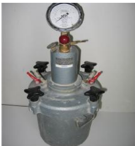
Slika 9: Naprava (porozimeter) za določanje vsebnosti zraka v betonski mešanici po metodi tlaka (Lafarge, 2012).
