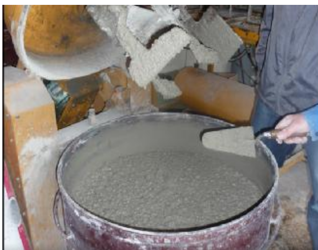
Slika 8: Priprava betonske mešanice v laboratorijskem mešalcu (Prinčič, 2012).
