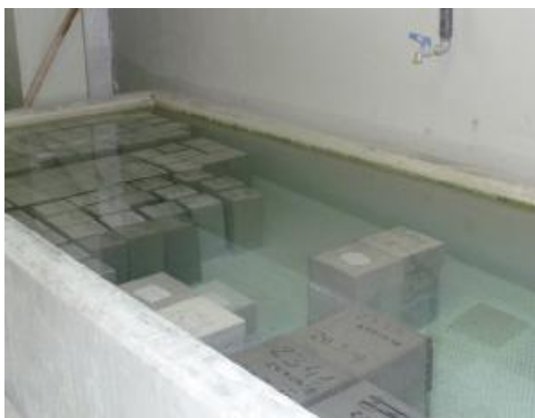
Slika 12: Nega betonskih kock v bazenih (Prinčič, 2012).
