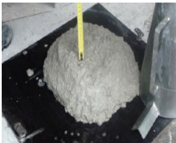
Slika 10: Določanje poseda svežega betona (Prinčič, 2012).
