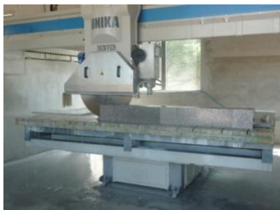
Slika 18: Rezanje betonskih kock na prizme (Prinčič, 2012).
