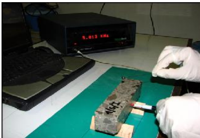
Slika 23: Merjenje frekvenc z napravo GrindoSonic (Prinčič, 2012).
