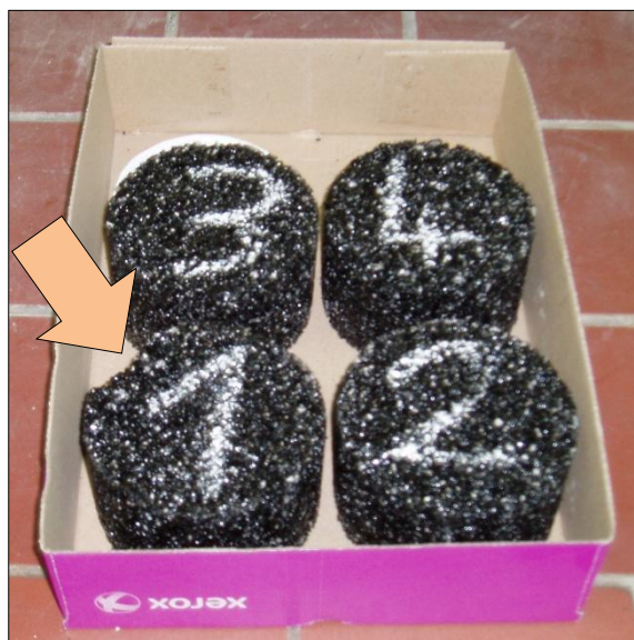
Slika 59: Preskušanci hladne bituminizirane zmesi segrete na sobni temperaturi
