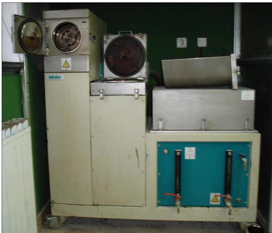
Slika 51: Naprava za avtomatsko ekstrakcijo veziva
