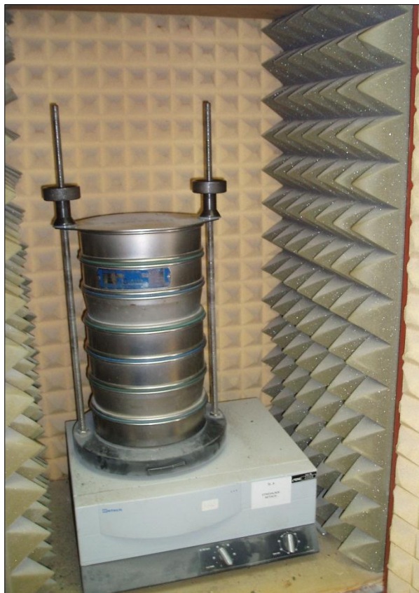
Slika 49: Stresalna naprava s sistemom sit
