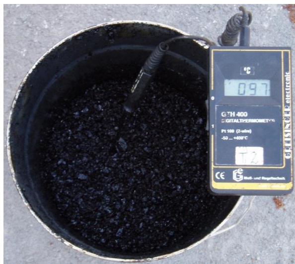
Slika 12: Temperatura vzorca tik po proizvodnji hladne asfaltne zmesi
