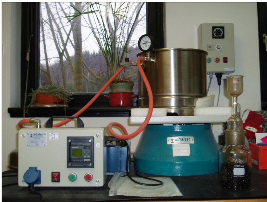
Slika 52: Piknometer z vzorcem in vakuumska posoda
