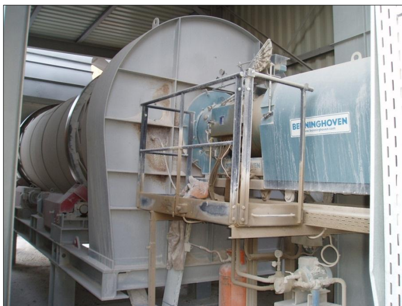
Slika 19: Sušilni boben z gorilnikom
