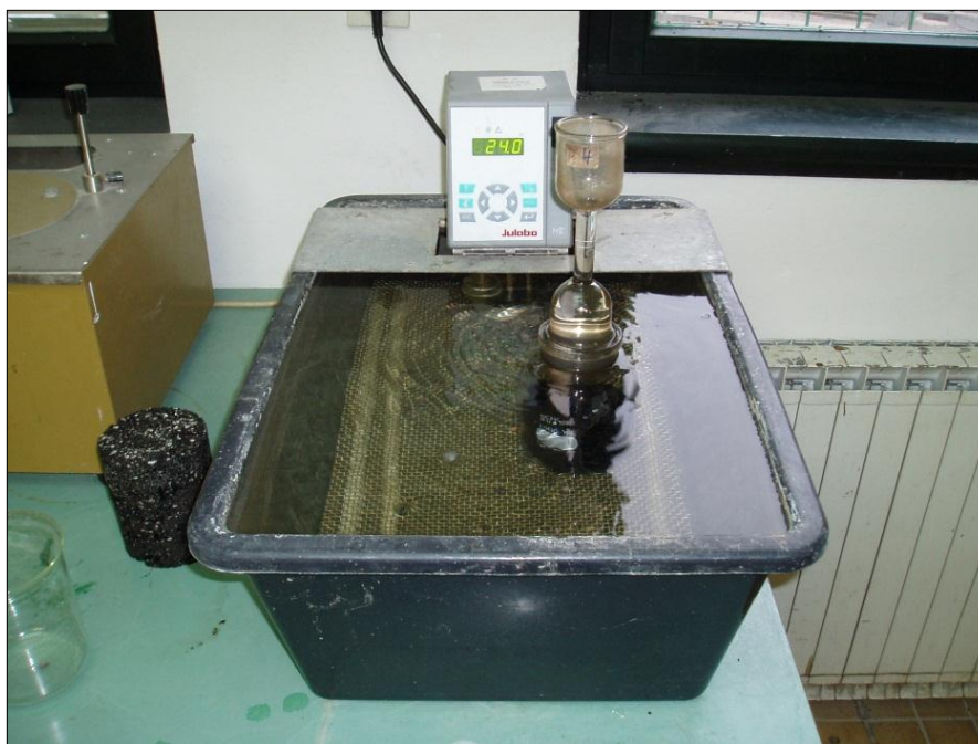
Slika 53: Piknometer z vzorcem v vodni kopeli
