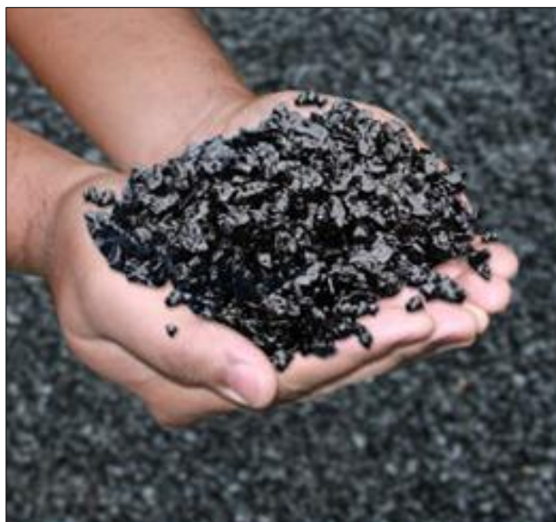
Slika 7: Hladna bituminizirana zmes (PLM Corporation, 2012) [5]
