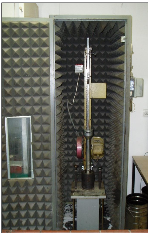
Slika 54: Udarni zgoščevalnik z jeklenim podstavkom in motornim pogonom
