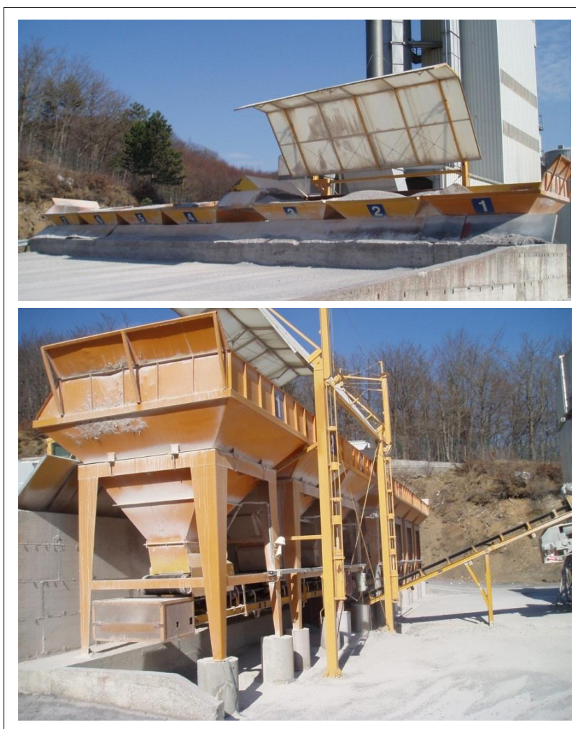
Slika 18: Preddozatorji s sistemom transportnih trakov
