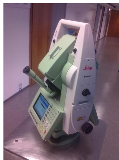
Slika 16: Zenit okular . za opazovanje tarč pri zelo majhnih zenitnih razdaljah.
