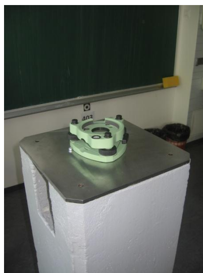
Slika 9: Prisilno centriranje na stebri.
