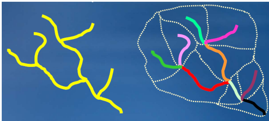
Slika 37: Razdelitev vodnega omrežja na segmente in določitev porečij (ArcGIS Spatial Analyst, 2008)
