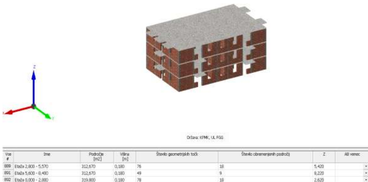
Slika 16: Primer obremenitve plošče za posamično nadstropje
