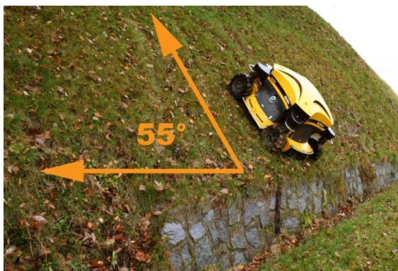
Slika 49: Daljinsko vodena kosilnica na ekstremnem naklonu (Slope Mower, 2012)
