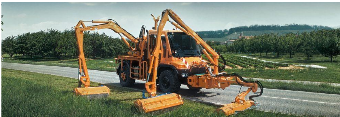
Slika 60: Specialno vozilo s tremi priključki za košnjo (Mercedes-Benz, 2012)
