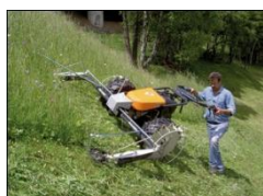
Slika 73: Delo z enoosno motorno kosilnico na brežini (Reform, 2012)
