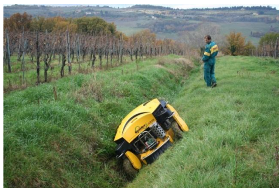
Slika 49: Daljinsko vodena kosilnica na ekstremnem naklonu (Slope Mower, 2012)
