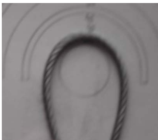
Slika 6.8: Gibka žica 3 mm pri polmeru R=30 mm
