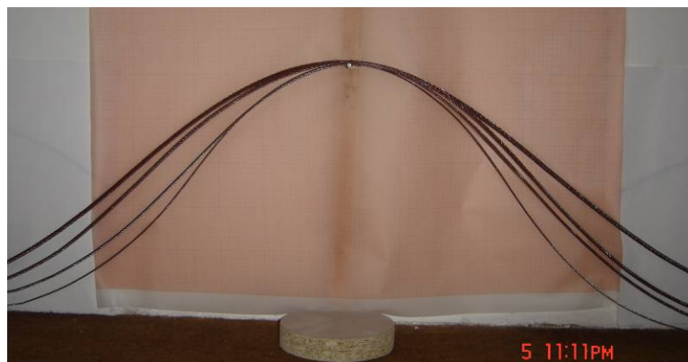
Slika 6.13: Na eni podpori podprte hkrati žice premera 2, 3, 4 in 5 mm
