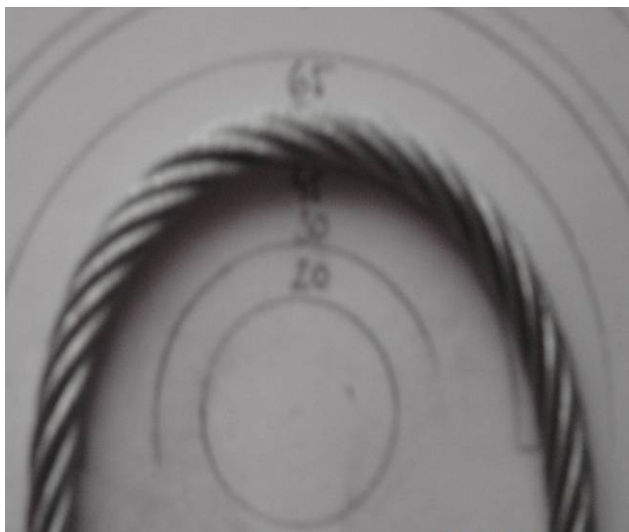
Slika 6.11: Žica debeline 5 mm, položena na polmeru R = 50 mm
