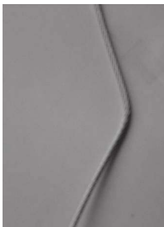
Slika 6.7: Deformacija gibke žice premera 2 mm
