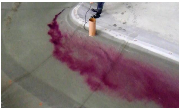
Slika 3: Vrtinčenje vode in mrtva cona s protitokom na zgornjem robu gradbene jame pri pretoku Q = 2460 \text{ m}^3/\text{s} .
