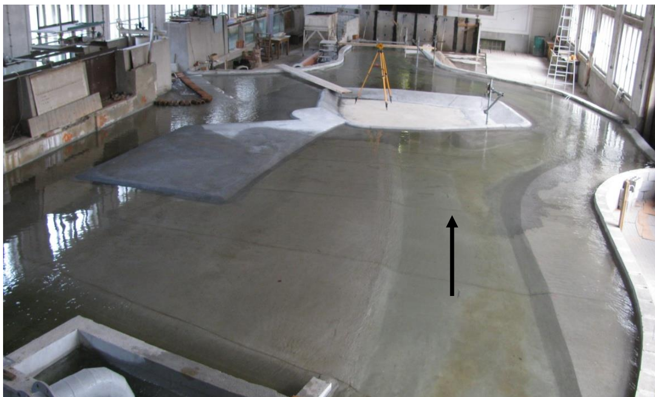
Slika 1: Fizični hidravlični model HE Brežice z vgrajeno gradbeno jamo in obtočnim kanalom. Puščica označuje smer toka vode.
