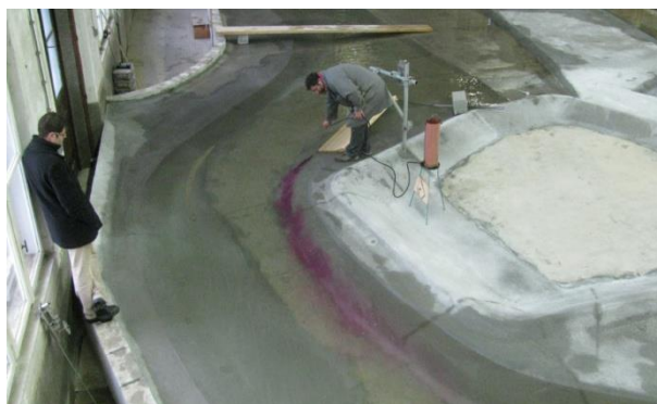
Slika 5: Tokovnice ob gradbeni jami pri zoženem vtoku v obtočni kanal. Pojavi se manjša zatišna cona vzdolž gradbene jame z manj izrazitimi vrtinci ob robu gradbene jame, ob hkrati manjšem izkopu Q = 1800 \text{ m}^3/\text{s} .
