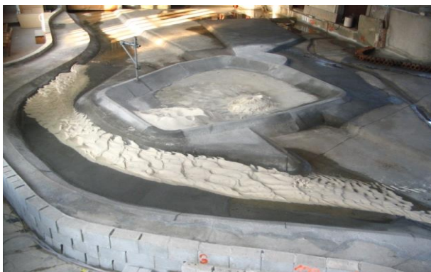
Slika 10: Močna erozija na konkavni polovici obtočnega kanala po 27 urah obratovanja pri pretoku Q = 1800 \text{ m}^3/\text{s} .
