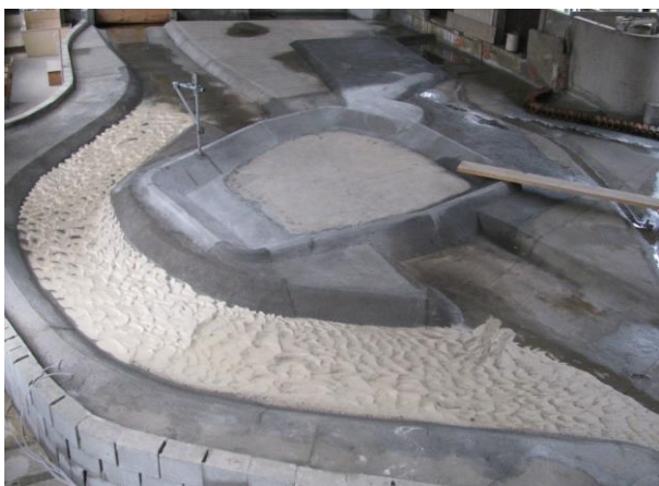
Slika 8: Stanje dna v obtočnem kanalu na fizičnem modelu po 11,7 urah pri pretoku 500 \text{ m}^3/\text{s} .
