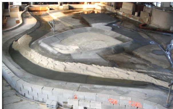
Slika 11: Ostanki proda na konveksni strani obtočnega kanala po 27 urah pri spodnjem robnem pogoju 143,96 m n. m. in pretoku Q = 1800 \text{ m}^3/\text{s} .
