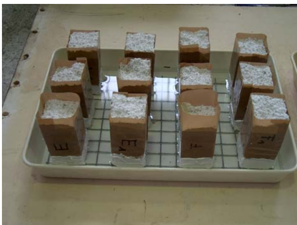
Slika 29: Prikaz vzorcev, ki skozi spodnji presek srkajo vodo;
