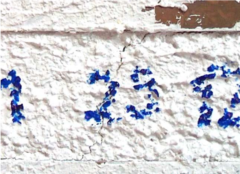
Slika 18: Prikaz prizmice, ki je med krčenjem razpokala
