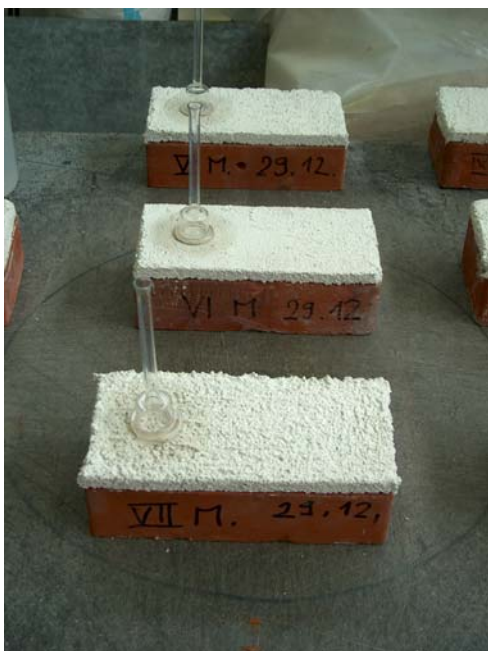
Slika 33: Prikaz zelo hitrega srka vode
