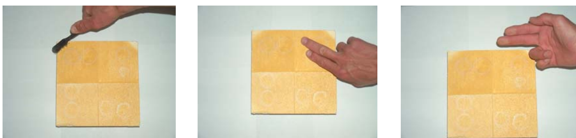
Slika 51: Ocenjevanje vezivne moči premaza
