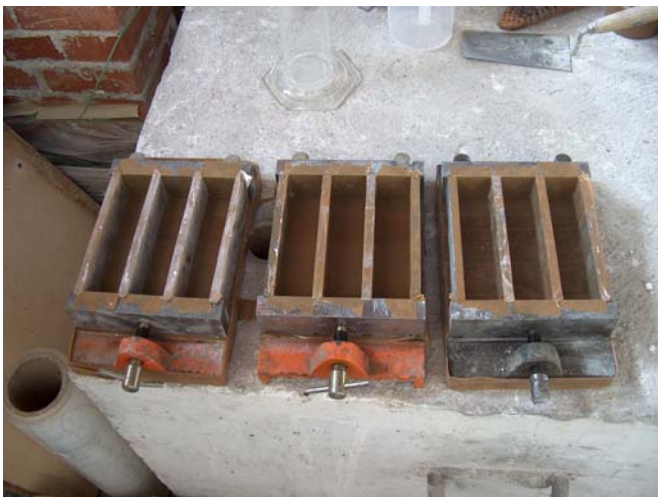
Slika 14: Pripravljeni kalupi za vgradnjo apnene malte
