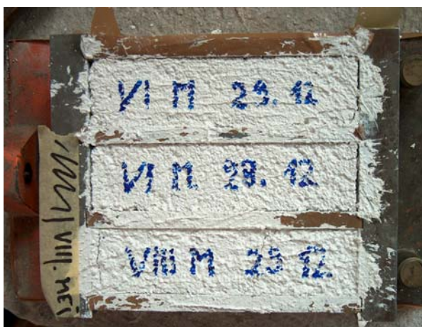
Slika 15: Prikaz krčenja apnene malte v kalupih
