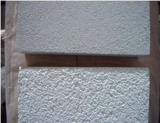
Slika 45: Primerjava grobe in fine zaribane malte
