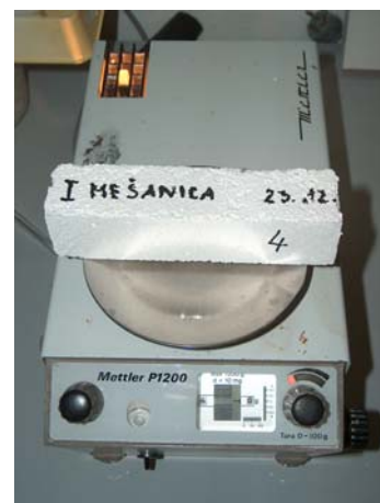
Slika 20: Tehtanje prizmic za določitev prostorninske mase
