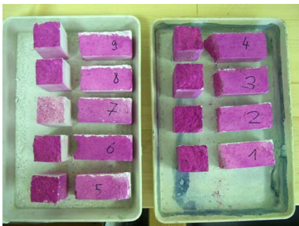
Slika 21: Določitev stopnje karbonatizacije maltnih prizmic
