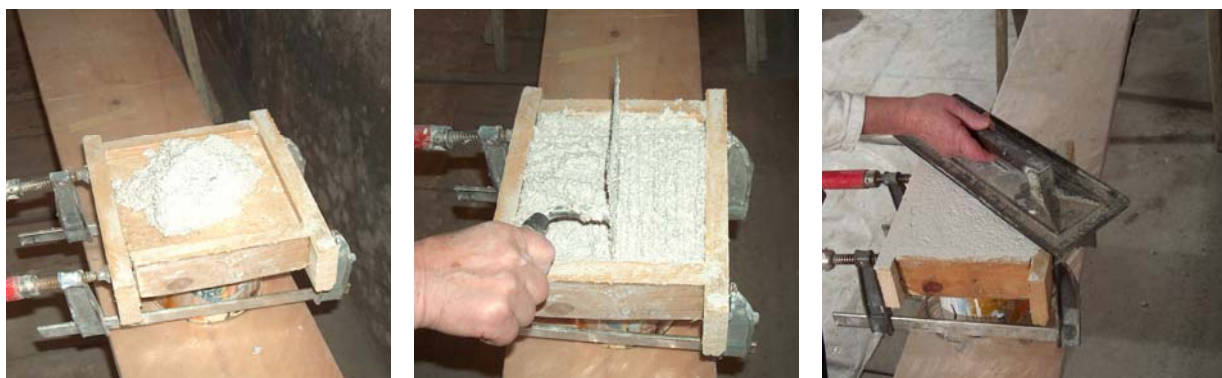
Slika 35: Izdelava grobega ometa na omočen lehnjak
