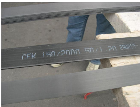
Slika 31: Lamela iz CFRP kompozitnega materiala (Bergant, 2012)
