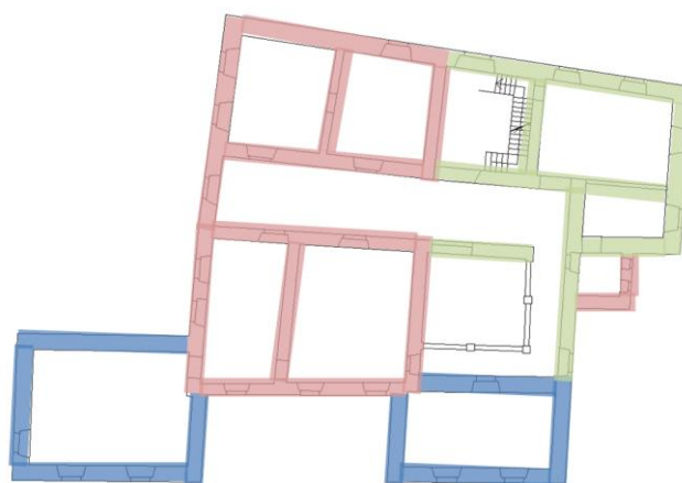
Slika 49: Razpored različnih materialnih karakteristik po tlorisu objekta
