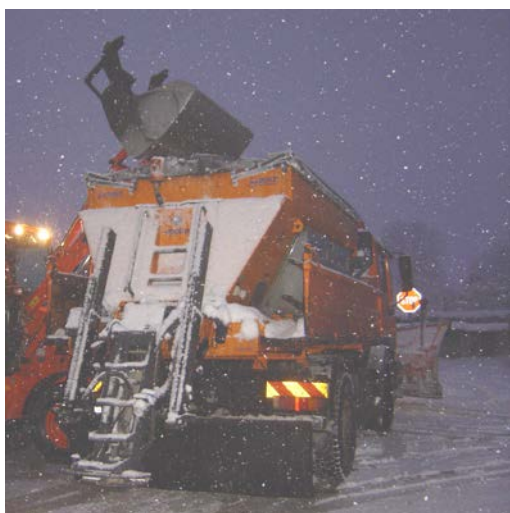
Slika 5: Vozilo z rotacijskim posipalcem (naprava za posipanje je postavljena na kamion)
