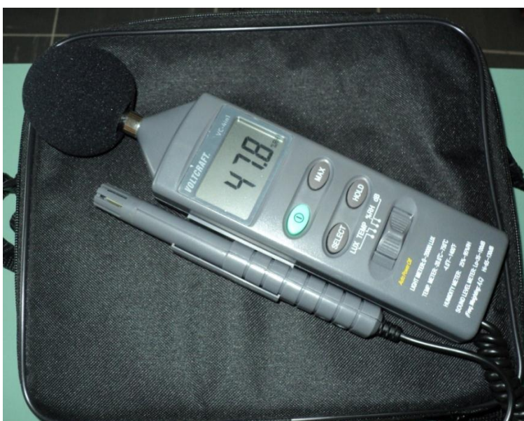
Slika 15: Okolijski merilnik VOLTGRAFT VC-4in1
