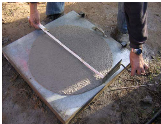
Slika 17: Merjenje razleza svežega betona (WhatWow, 2010)
