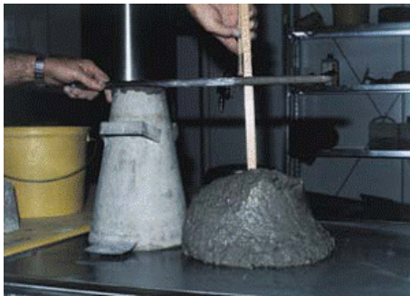
Slika 4: Primerjava konsistenc lahkovgradljivega(levo) in SCC betona (desno)
