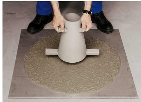
Slika 4: Primerjava konsistenc lahkovgradljivega(levo) in SCC betona (desno)
