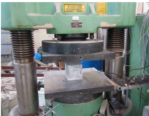
Slika 19: Tlačna preša (levo) in tlačna porušitev vzorca (desno)
