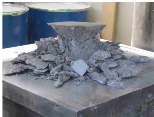
Slika 19: Tlačna preša (levo) in tlačna porušitev vzorca (desno)
