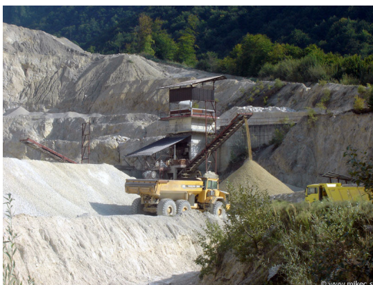
Slika 5 : Pridobivanje drobljenega agregata v kamnolomu (Mikec, 2008)
